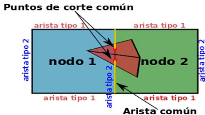
Figura 54. Arista común a dos nodos. Sólo se calculan los puntos de corte una vez.
