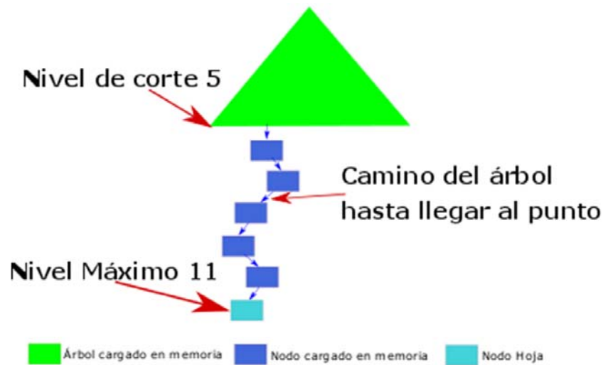
Figura 84. Almacenamiento en memoria principal de los nodos necesarios para saber si un punto está incluido o no en un objeto.
