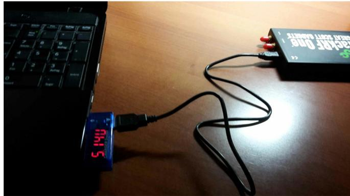
Figura 3.9 – Imagen del medidor de V/A.
