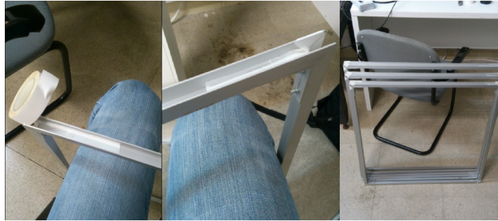
Figura 5.2 – Montaje de estructura para bobinas de Helmholtz cuadradas
