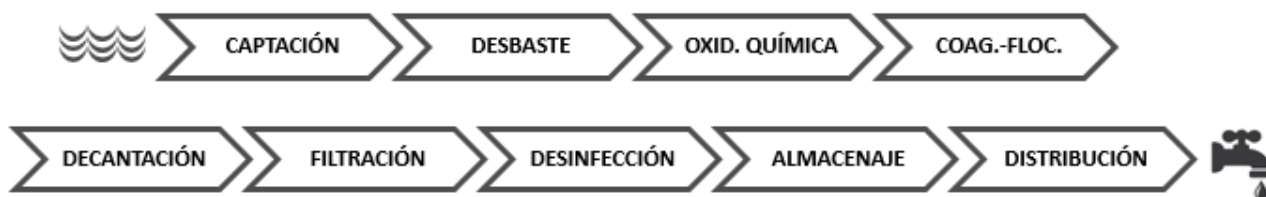
Figura 2. Línea de tratamiento de una ETAP convencional.
