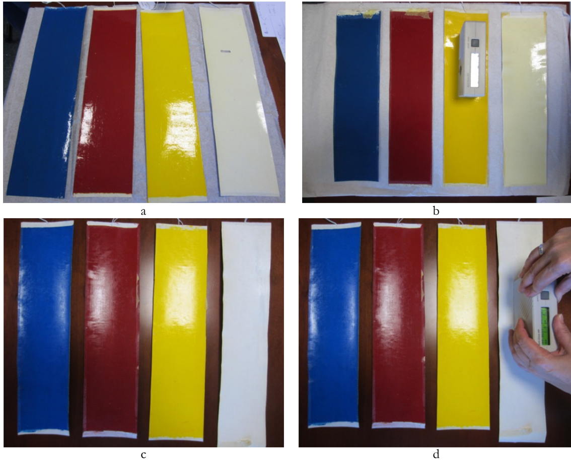
Figura 89.- Muestras patrón: a) barniz de almáciga, b) barniz de almáciga envejecido, c) barniz acrílico, d) acrílico envejecido y medición de brillo antes de la limpieza
