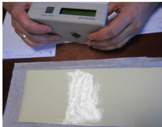
Figura 121.- Medición de brillo del barniz de almáciga sobre óleo blanco de cinc
