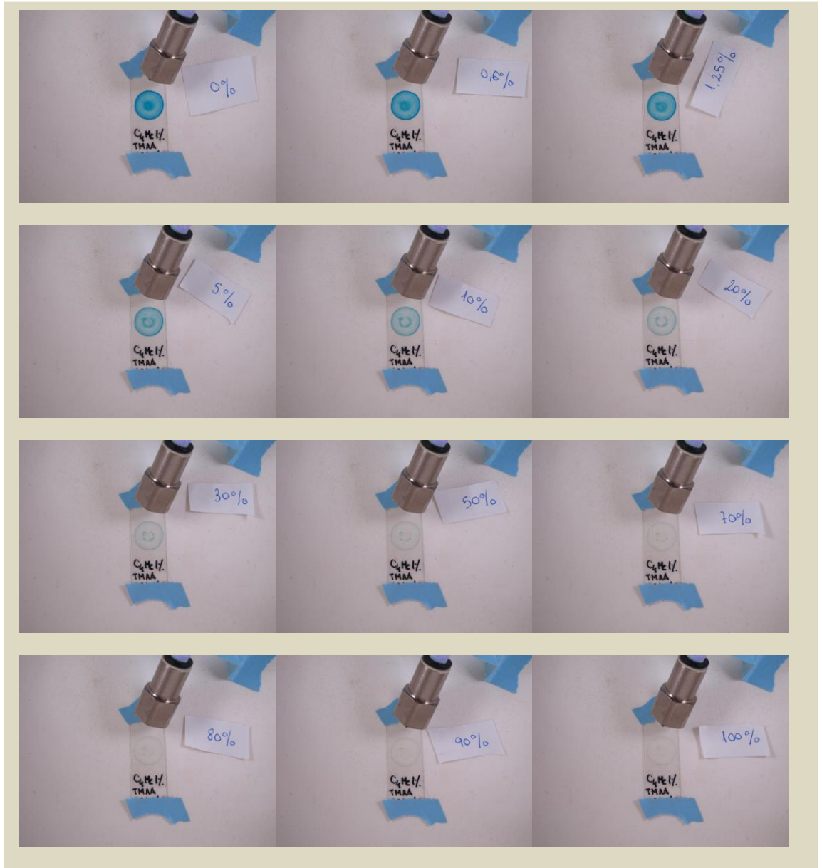
Figura 4.54. Fotos de la membrana C1 a distintas concentraciones de CO 2
