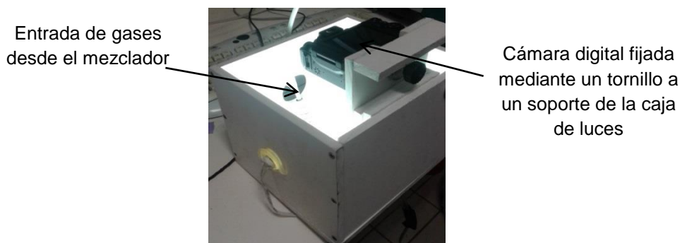
Figura 2.5. Caja de fabricación propia donde se lleva a cabo la captura de imágenes mediante una cámara fotográfica.
