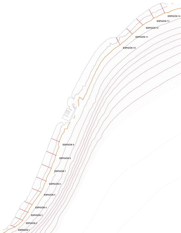
Figura 6: Obras de contención diseñadas para la alternativa 1.
