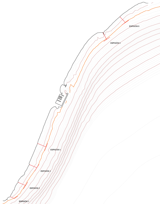
Figura 7: Obras de contención diseñadas para la alternativa 2.
