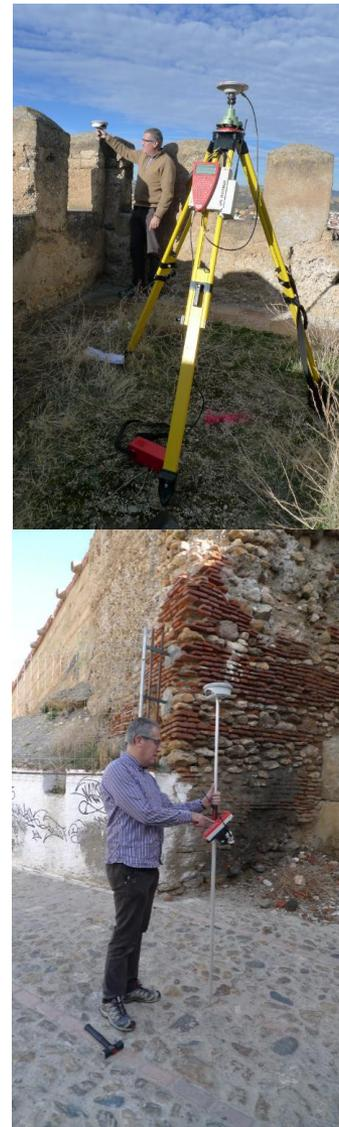
(imagen arriba) Equipo de referencia situado en una de las torres para evitar oclusiones. (imagen abajo) Medición de punto de apoyo exterior en la calle Muralla. Este punto sirvió de base para el posterior estacionado del taquímetro electrónico. En esta ocasión la antena se sitúa sobre un jalón de 2 m. (J.A.Benavides)
