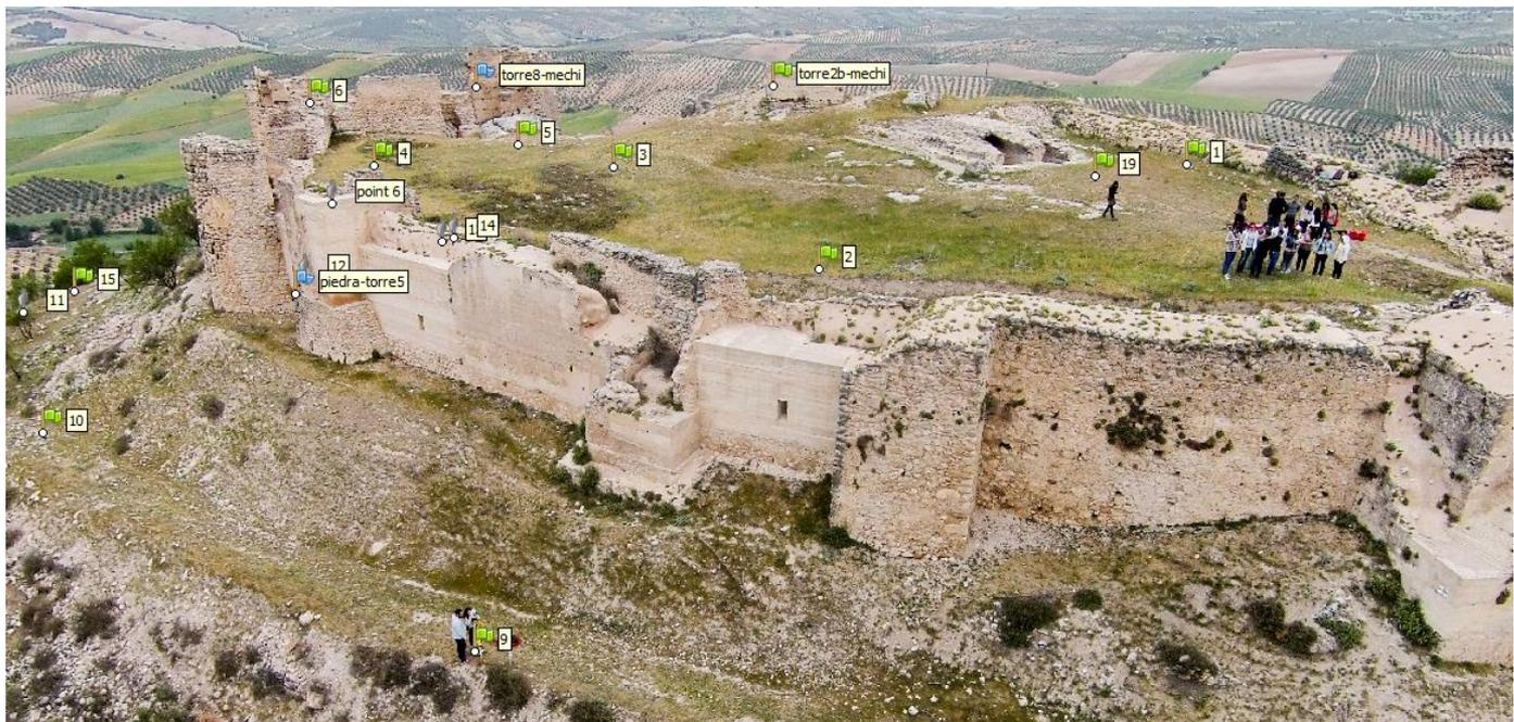
Puntos de apoyo topográfico. En verde puntos de apoyo visible en este imagen. En gris, puntos de apoyo del modelo no utilizados para esta imagen. (J.A.Benavides)
