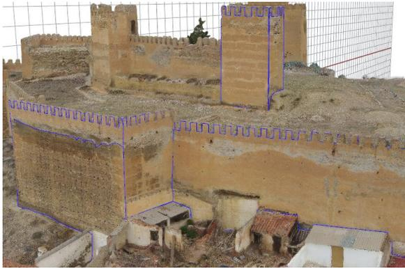
Modelo tridimensional con secciones a 10 cm. Vista del modelo dibujado en 3D realizado sobre Rhinoceros 5.0. (J.A.Benavides)
