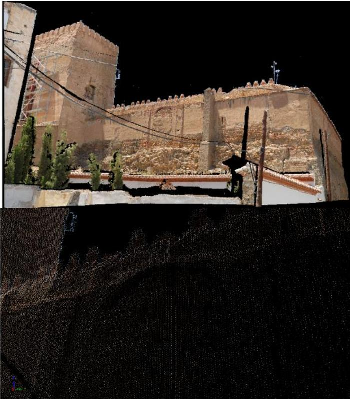
Nube de puntos capturada desde la esquina Sureste de la Alcazaba. La vista alejada proporciona una imagen que, aparentemente, dispone resolución fotográfica. En la imagen derecha se observa que al aumentar la escala, los puntos se separan, dejando de tener continuidad e impidiendo observar sus formas.
