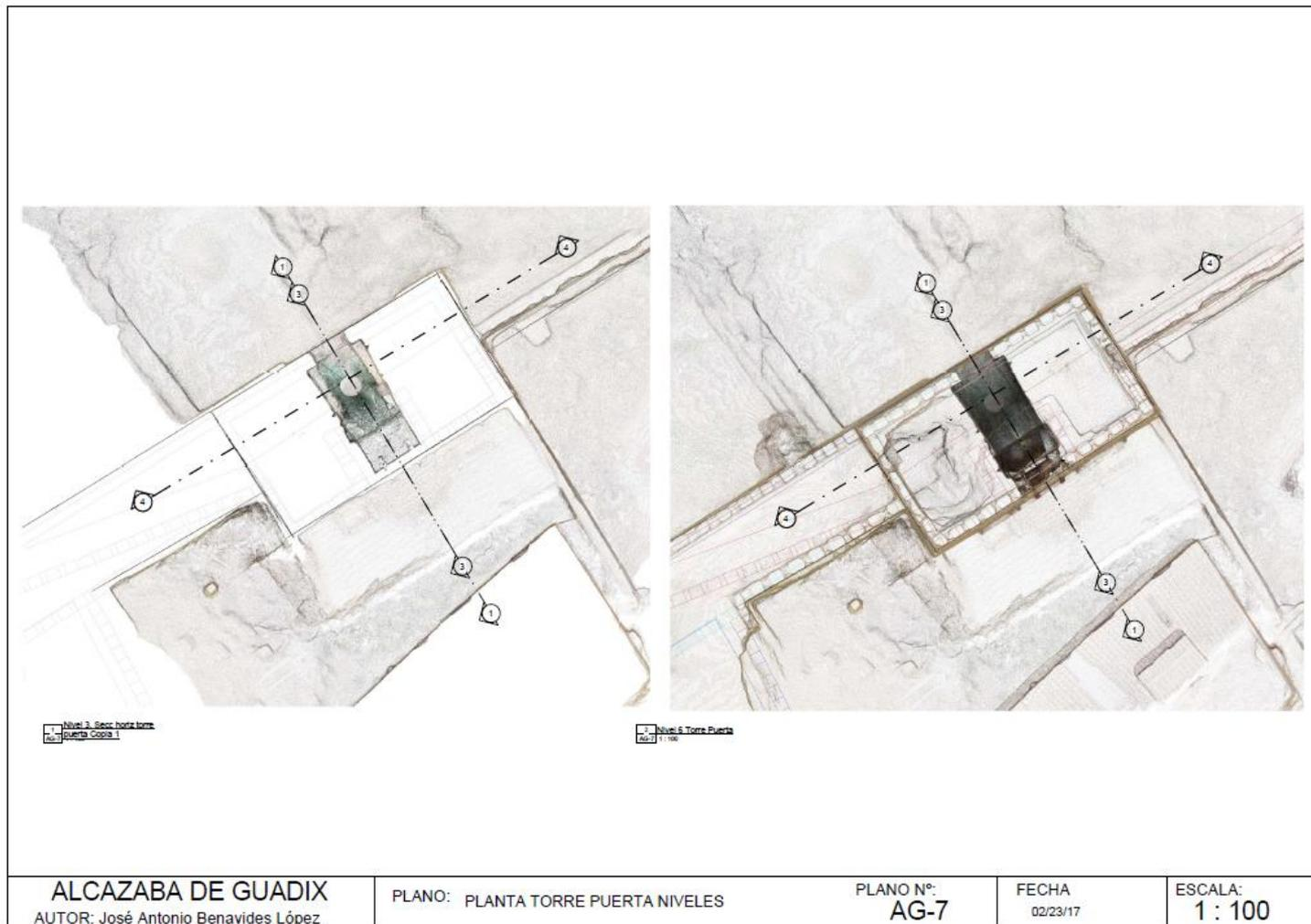
Planos de planta a diferente nivel de la torre puerta sureste, a partir de la gestión de la nube de puntos generada por el modelo fotogramétrico.(J.A.Benavides)
