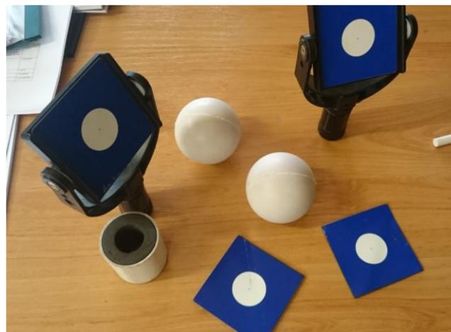
Imagen de tipos dianas y puntos de referencia. Planas, cilíndricas y esféricas.
