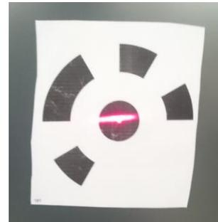
La medición tangencial del rayo láser pueden provocar errores de varios centímetros.
