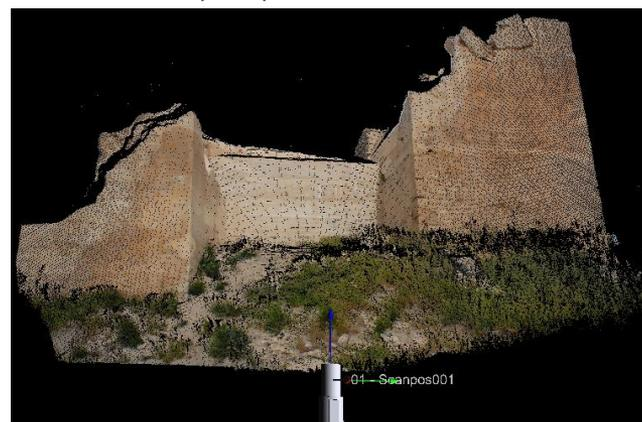
Filtrado de puntos realizada en el post proceso. Mismo modelo de la imagen anterior en la que la nube de puntos se ha reducido a 221.943 puntos para una resolución 2 cm. (J.A.Benavides)
