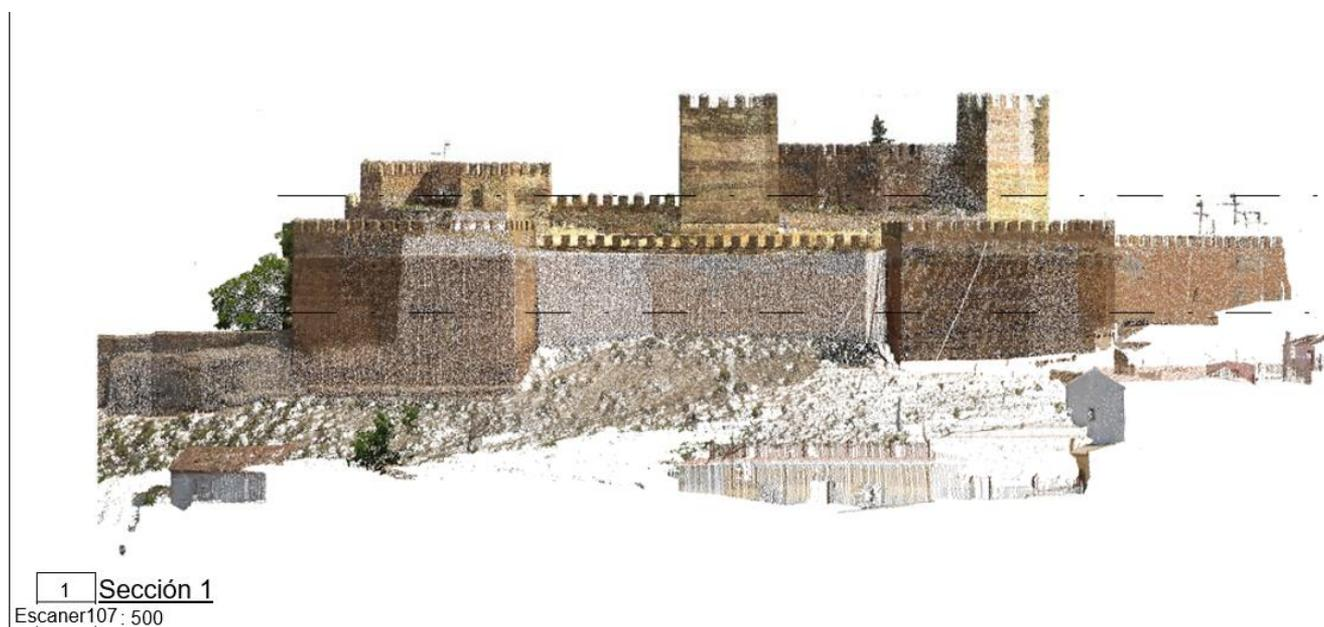
Alzado oeste de la nube de puntos de la Alcazaba de Guadix obtenida a través de Autodesk Revit
