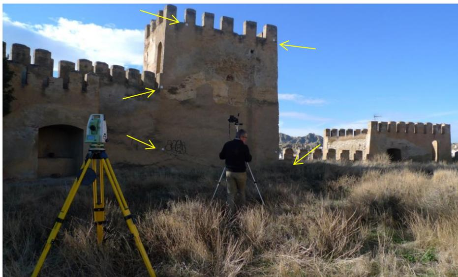
Dianas adhesivas situadas sobre el paramento y que constituyen los puntos de apoyo fotogramétrico.
