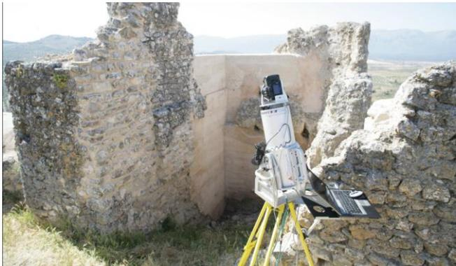
Equipo de escáner utilizado *Riegl Z420i* . Captura del interior de la torre 8
