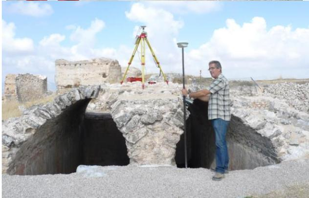
Levantamiento de los puntos singulares y puntos de apoyo mediante estaciones totales y equipo GPS-RTK
