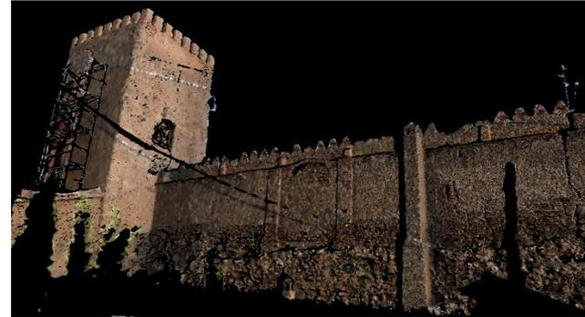
Suavizado y decimado de la malla correspondiente al escáner “esquina calle Amezcua”. La interpolación entre de los colores de los vértices produce superficies no contrastadas.
