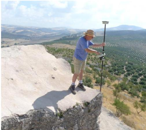
Medición mediante DGPS de los puntos singulares accesibles de las estructuras.
