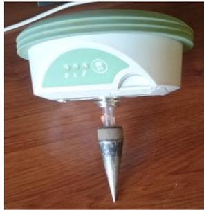
Colocación de pieza de punta de jalón en la base de la antena para medir con precisión elementos accesibles, minimizando el error de verticalidad.
