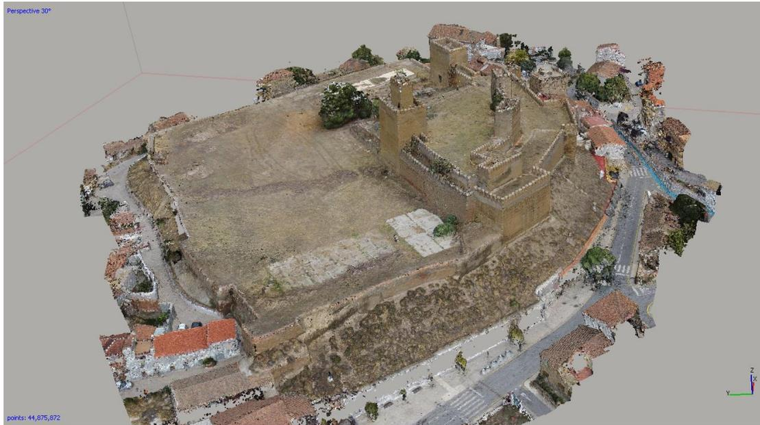
Perspectiva desde oeste de nube de puntos densa. La alta densidad de puntos (44.875.872 puntos) permite su visualización a esta escala como si se tratara de un sólido.(J.A.Benavides)
