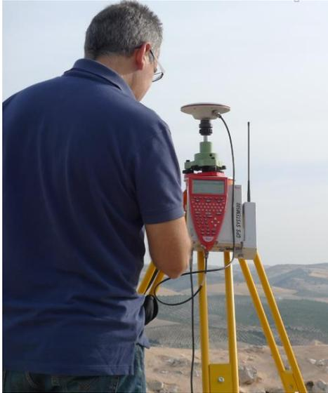
Medición de los puntos de apoyo sobre los paramentos mediante estación total Leica TS06 (izquierda). Georreferenciación de las bases a partir de equipo GPS-RTK (derecha)
