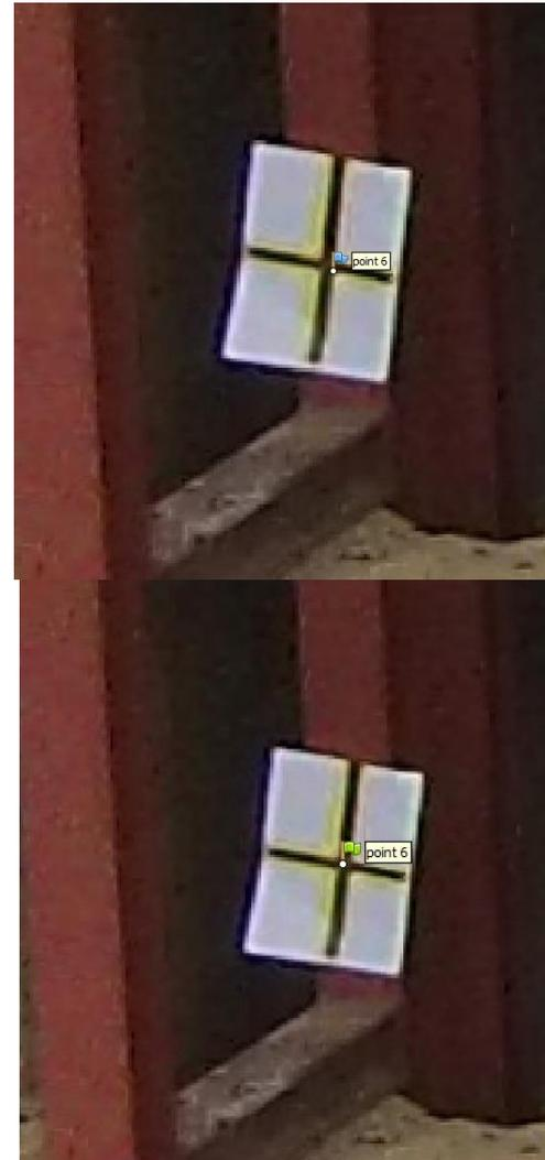
Estimación de la posición del punto (izquierda). Situación exacta del punto medido (derecha). Si bien aparentemente el desplazamiento del punto de control es pequeño (imagen izquierda), este puede provocar grandes errores en puntos más alejados
