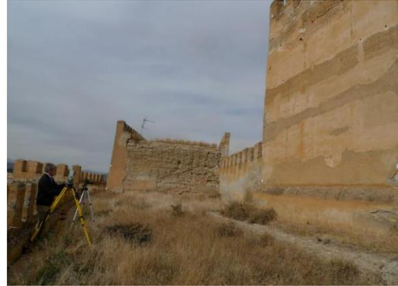
Dificultad de medición de los puntos de apoyo por visuales muy inclinadas. A la imposibilidad de visualizar el punto a través del anteojo se suma el error provocado por la trayectoria tangencial del rayo láser respecto del paramento.
