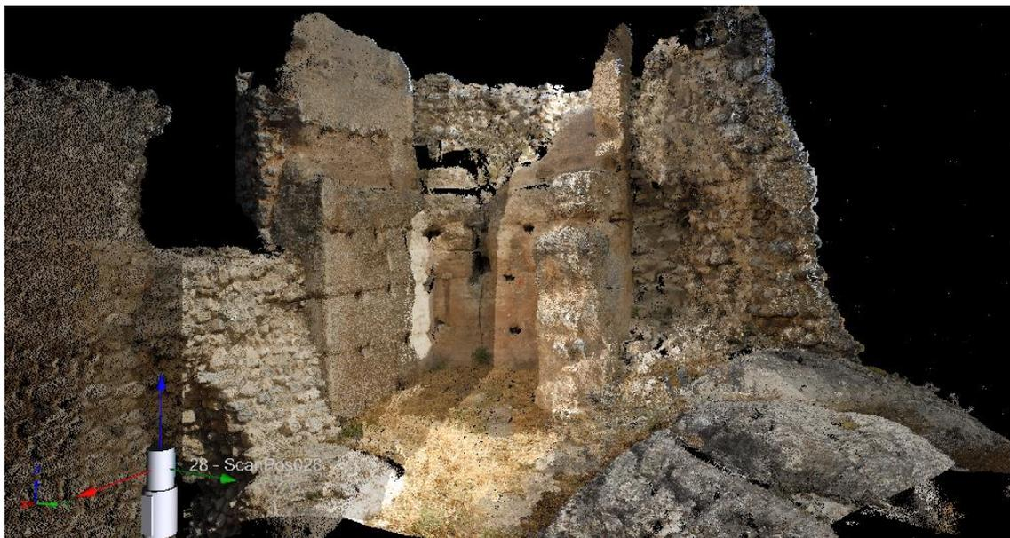
Imagen del modelo interior de la torre 5 texturizada desde las posiciones 27 y 28. Los problemas de cambio de tono en la textura se pueden solucionar mediante su ajuste en programas de tratamiento fotográfico de imágenes.(J.A.Benavides).
