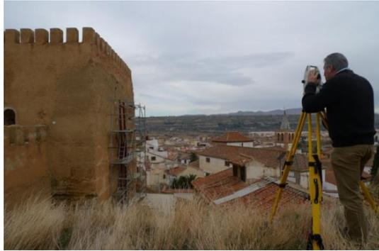
Captura tangencial de puntos de apoyo sobre el alzado sur de la torre-puerta.
