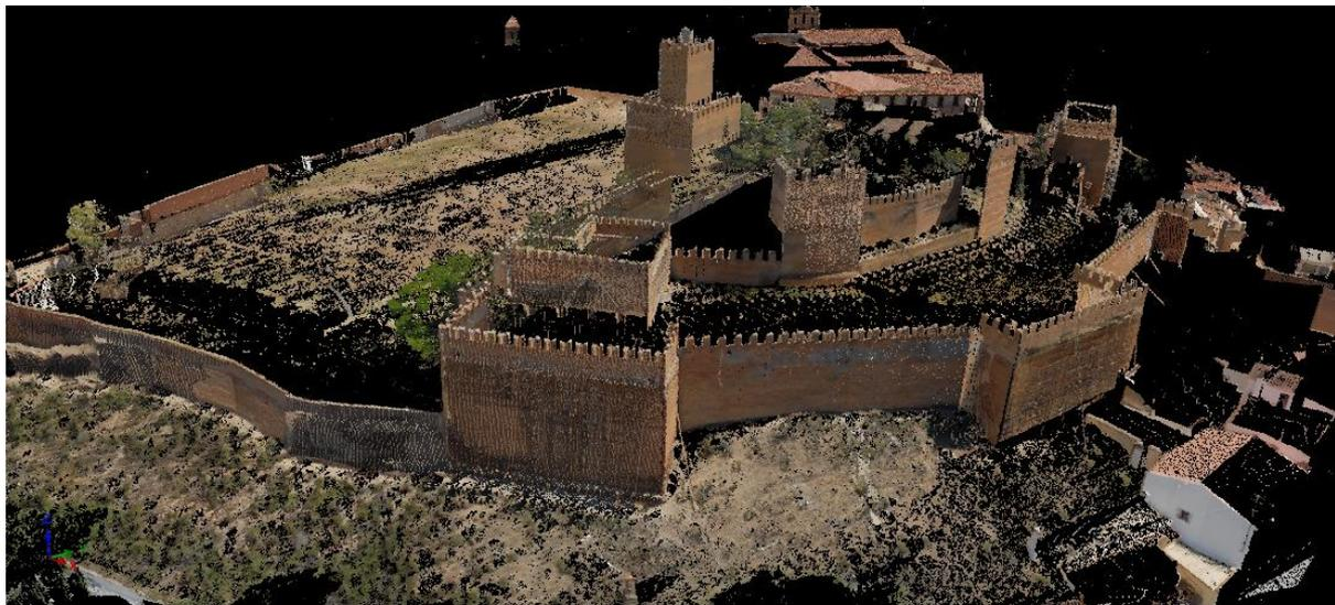
Imagen resultado del ajuste bruto ICP entre las nubes de puntos "Cerro Magdalena" y "Techo cueva" de la alcazaba de Guadix.
