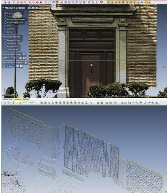
Generación de secciones automáticas a partir de la nube de puntos. (J.A.Benavides)
