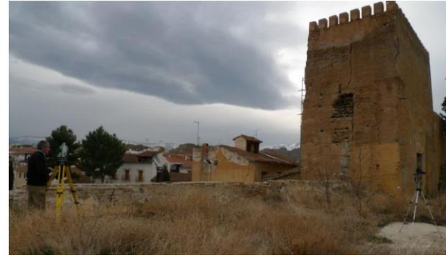
Medición de puntos de apoyo en el alzado este de la torre puerta. El análisis comparado entre los modelos de nubes de puntos con apoyo en todos sus paramentos o solo en dos opuestos nos ha permitido demostrar la validez de los dos modelos. (J.A.Benavides)
