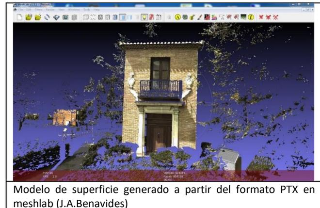
Modelo de superficie generado a partir del formato PTX en meshlab (J.A.Benavides)
