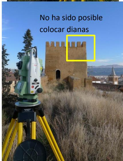
Medición de puntos de apoyo fotogramétrico desde diferentes posiciones. En el caso de que sea imposible colocar dianas por no accesibilidad es necesario medir puntos singulares (manchas, puntillas, esquinas bien marcadas, etc.)
