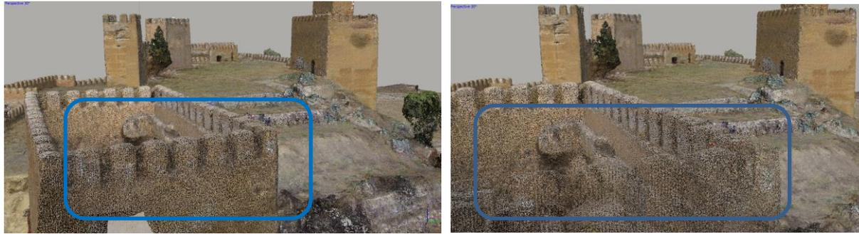
Detalle de diferente apreciación de la nube de puntos en función de la escala de visualización. Al aproximarnos a nube solo apreciamos puntos inconexos sin definición de objetos. Los objetos lejanos, representados a menos escala siguen definiendo formas que parecen compactas.
