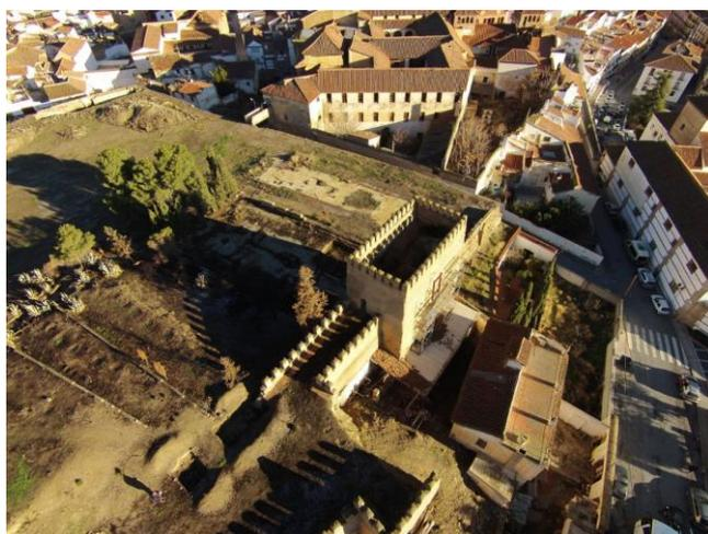
Captura de imágenes adicionales desde todos los puntos de vista. Evitan la falta de solape necesario para la generación del modelo tridimensional completo. Imagen cenital y oblicua de la torre-puerta de la alcazaba de Guadix.
