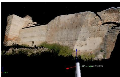
Imagen de la nube de puntos texturizada de los escaneado registrados: Scan 4, 5 y 6. La diferencia de iluminación en las distintas tomas provoca cambios en la textura no deseados.(J.A.Benavides).
