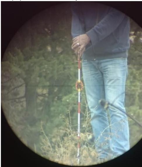
Levantamiento de puntos de apoyo (dianas) situados sobre el suelo mediante distancimetría infrarroja sobre mini-prisma o posicionamiento mediante DGPS (izquierda). La medición de los puntos de apoyo situados sobre paramentos de fachada se ha realizado por distancimetría laser.
