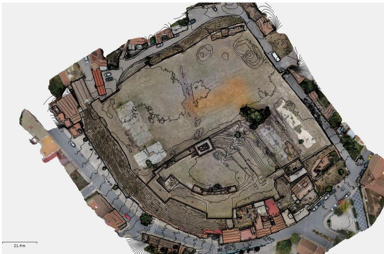
Superposición del plano con curvas de nivel 0.5m sobre ortofotografía digital de la planta. .(J.A.Benavides)
