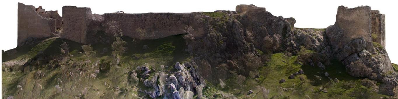
Ortofotografía del alzado norte con resolución de 1cm.
