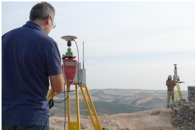
Equipo GPS-RTK (precisión centimétrica). Permitió la Georreferenciación directa del escáner mediante la colocación de la antena móvil sobre el soporte específico para ello.
