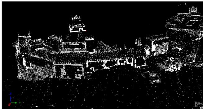
Polydata generado por filtrado plano (5 mm) de la nube de puntos correspondiente al escáner "techo cueva" formado por 31430 puntos y 9097 polígonos. (J.A.Benavides)
