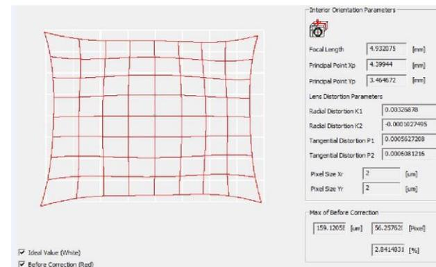
Resultado y esquema de las deformaciones de la imagen a partir del proceso de calibración. Indicación de los parámetros de orientación interna. En color blanco se muestra los valores ideales y en rojo las deformación de la imagen.
