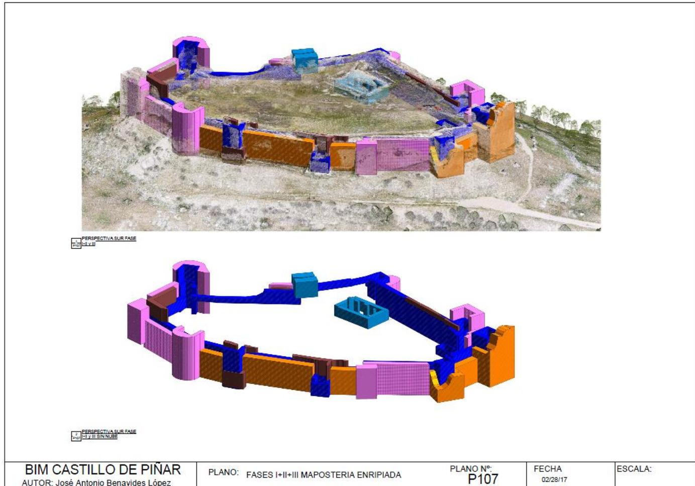
Perspectiva del modelo BIM correspondiente a las fases III (refuerzo de torres y murallas mediante mampostería enripiada), representado en color magenta y la fase anterior Fase II (refuerzo de torres y murallas con muros de tapias calicastro), representado en color anaranjado.
