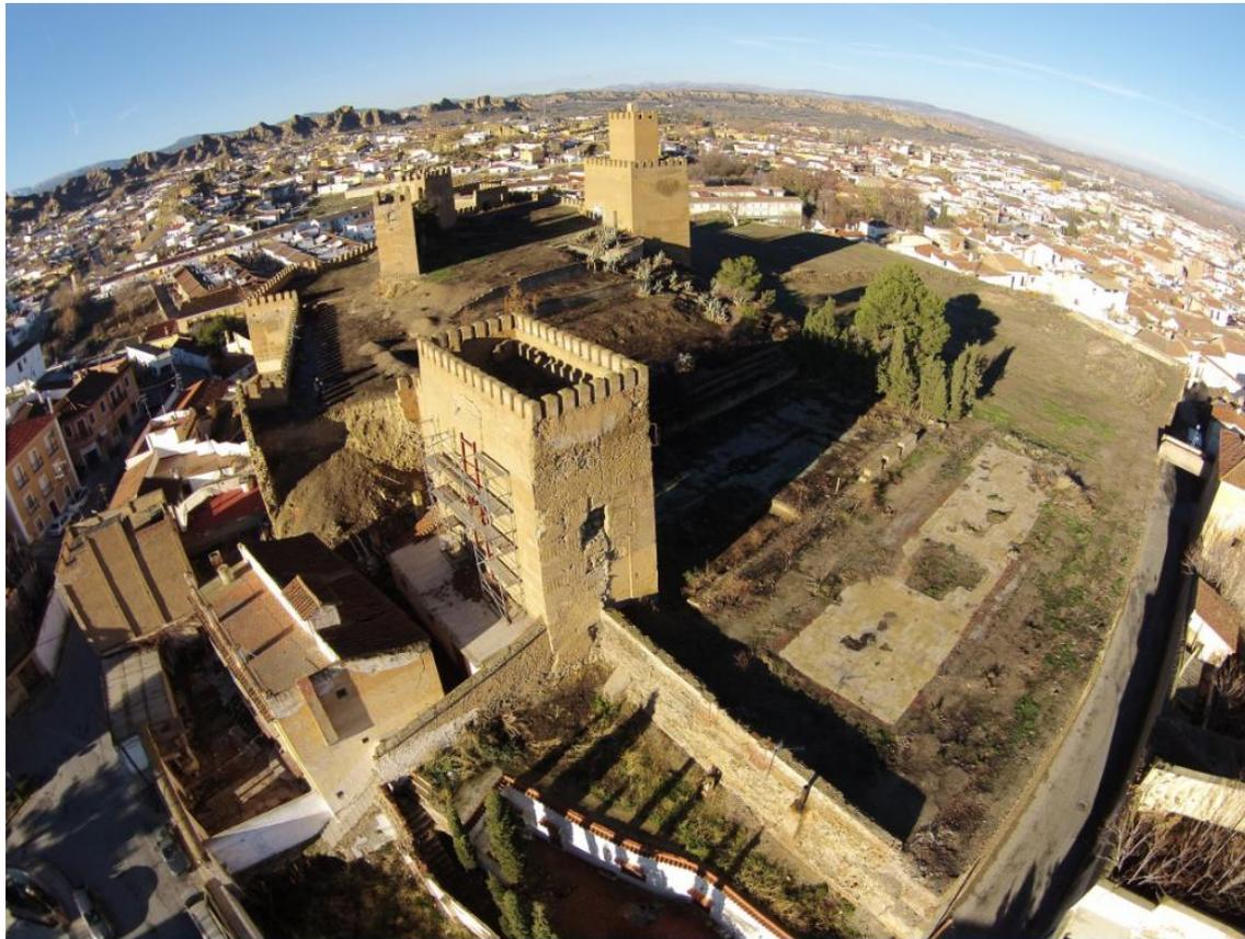
Las nuevas tecnologías fotogramétricas aportan numerosas ventajas en los levantamientos arquitectónicos y arqueológicos. La fotogrametría multimagén mediante *drone* a baja altura aprovecha la gran resolución de las imágenes de objeto cercano con el nuevo punto de vista desde el aire evitando las oclusiones propias de la fotogrametría terrestre.
