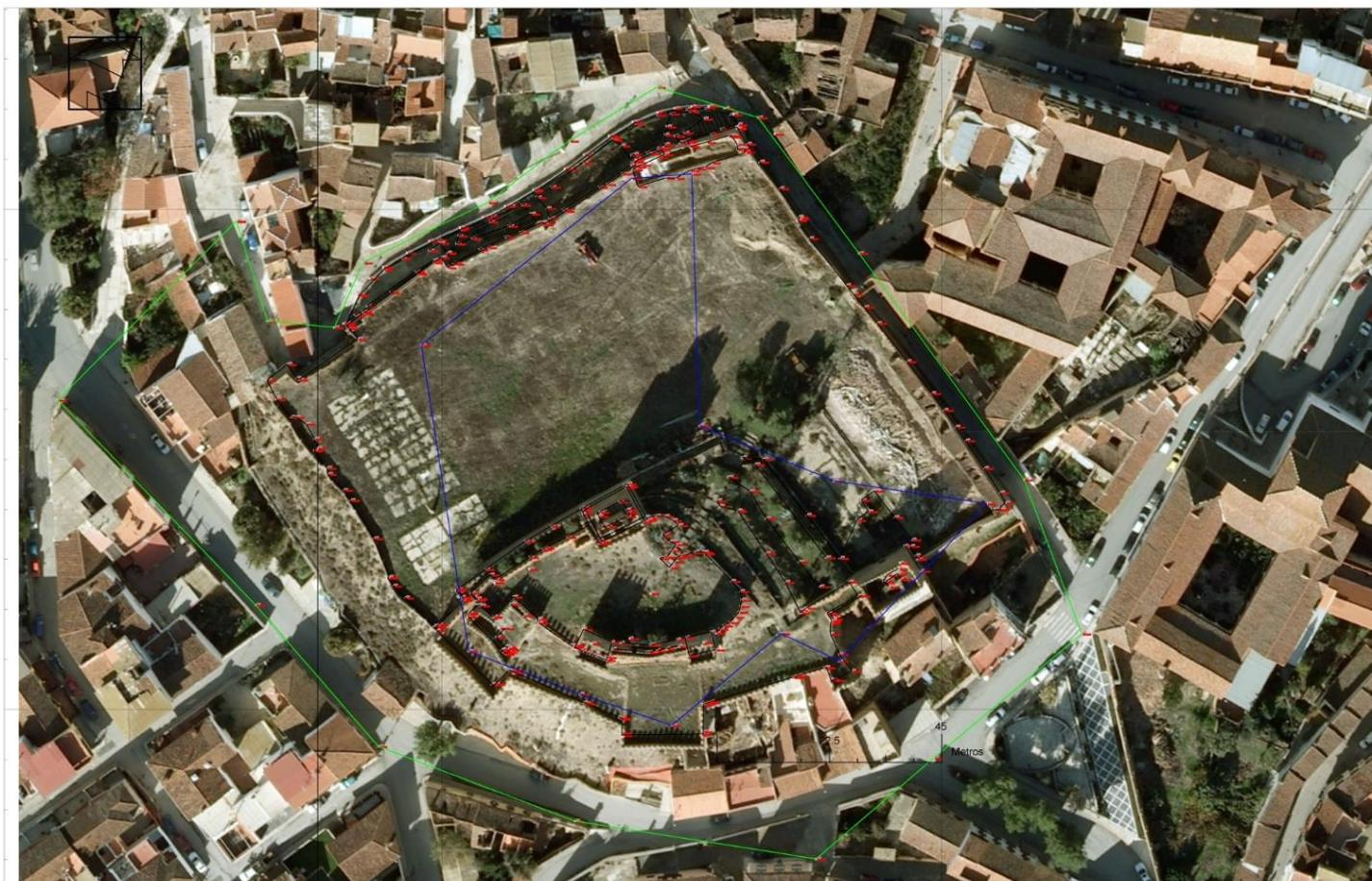
LEVANTAMIENTO GPS DE PUNTOS DE APOYO, ESTRUCTURAS Y BASES ESTACIONADO EXTERIORES E INTERIORES UTM30-ED50
