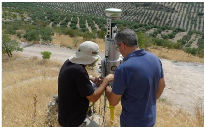
Estacionado de escáner sobre un punto de coordenadas conocidas a partir de la posición dada por el GPS – RTK. La orientación aproximada se realiza a partir de una brújula.
