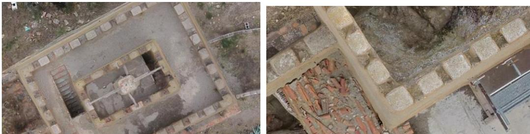
En estas vistas se observa el alto grado de detalle que se obtiene al generar una ortofotografía. La resolución de la imagen se corresponde con el tamaño del GSD (tamaño del pixel sobre la realidad). (J.A.Benavides)
