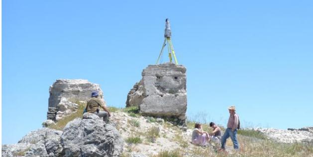
La captura de la parte superior de las estructuras plantea graves inconvenientes con el posicionado de escáner laser entrañando riesgos para los operadores. El trípode soporte del escáner dificulta la captura generando zonas de sombra.(J.A.Benavides).
