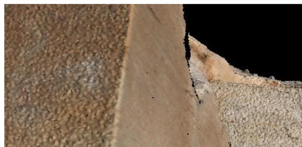
La diferente densidad de puntos y los errores instrumentales de medición del láser provocan mallas no homogéneas, con diferentes grados de rugosidad que provocan mala resolución en el texturizado. (J.A.Benavides)
