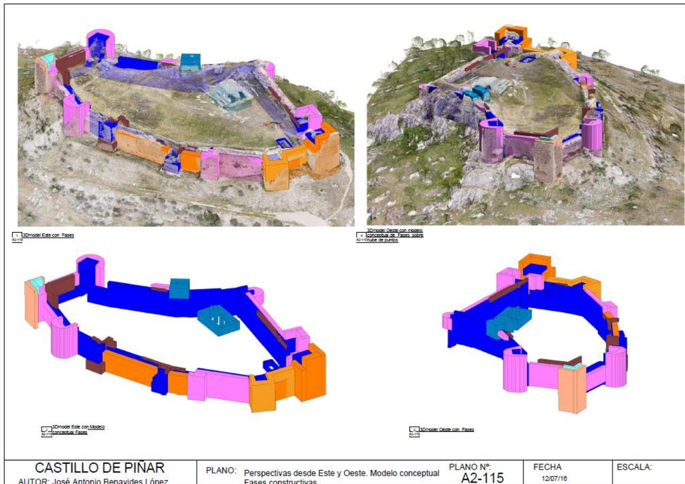
Plano de vistas este y oeste del modelo tridimensional de las fases constructivas. En la vista superior se observa la superposición del modelo reconstruido sobre la nube de puntos. Formato A2.
