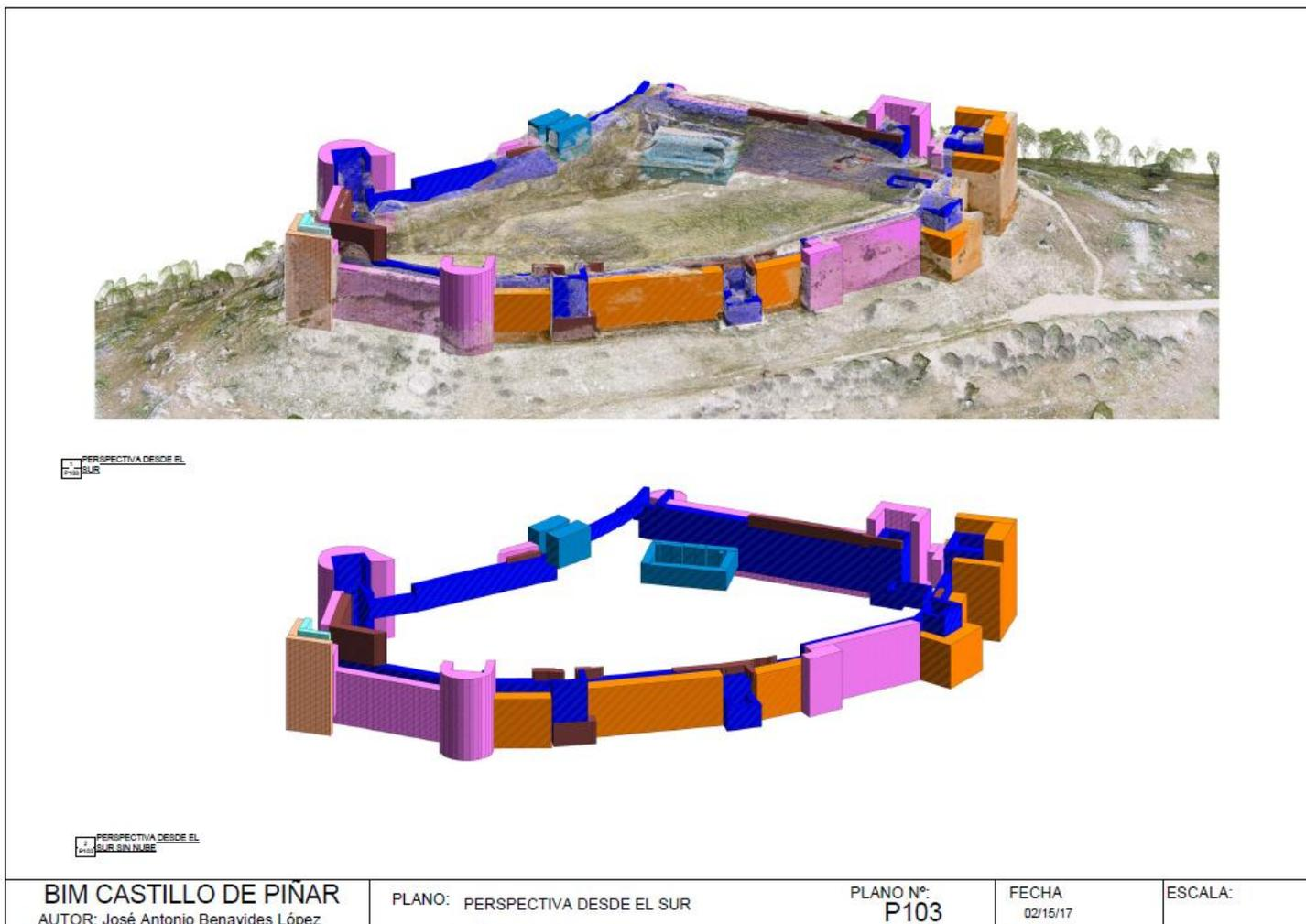
Plano de la vista sur del modelo tridimensional de las fases constructivas. En la vista superior se observa la superposición del modelo reconstruido sobre la nube de puntos. Formato A2.
