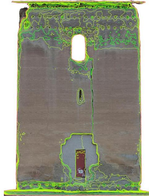
Representación mediante curvas de nivel con equidistancia 5 cm. del relieve, deformaciones o erosiones del alzado Este de la torre de Romilla. (J.A.Benavides)
