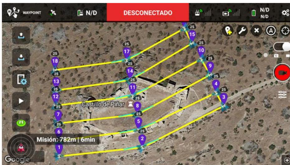
Planificación en campo del vuelo cenital para el castillo de Piñar. En cada waypoint (punto de paso) es necesario definir la altura deseada para la aeronave respecto del punto inicio de despegue.
