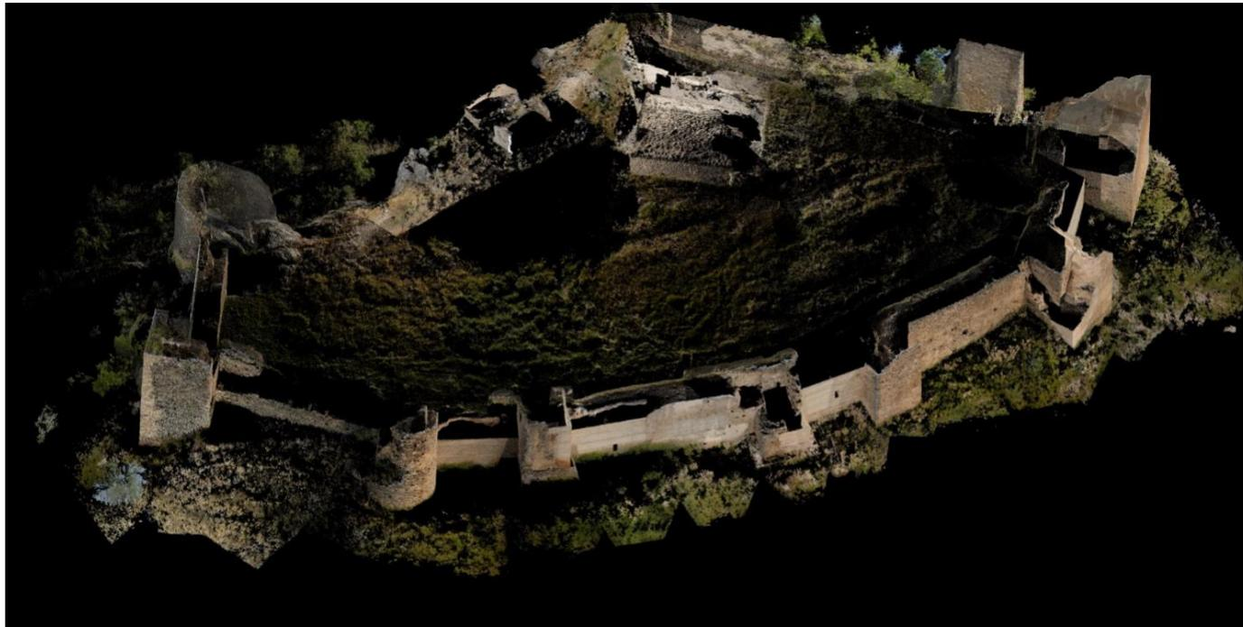
El trabajo llevado a cabo en el Castillo de Píñar mediante láser scanner 3D (TLS) ha permitido construir un modelo 3D texturizado del complejo arquitectónico que sirviera de base para el proyecto de restauración y consolidación llevado a cabo en el año 2010.
