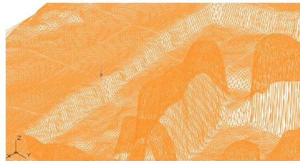
Superficie DEM generada a partir de la malla irregular. Es una malla regular continua que determina la elevación del modelo en cada uno de sus vértices. (J.A.Benavides)
