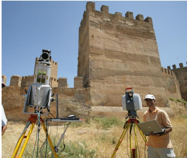
Equipos de escáner utilizados: Riegl Z420i (izq) y Scan Station2 de Leica (der). La utilización conjunta en determinadas zonas nos permitió realizar análisis comparativos.
