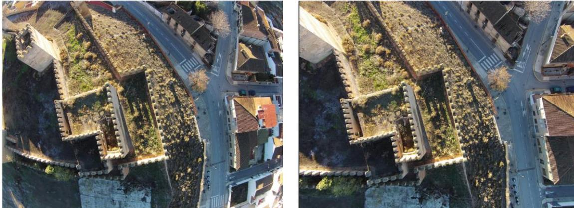
(izq.) Imagen distorsionada por la deformación de una lente gran angular; (der) Misma imagen corregida la deformación por *software* (Lightroom, photoshop, ptlens...).
