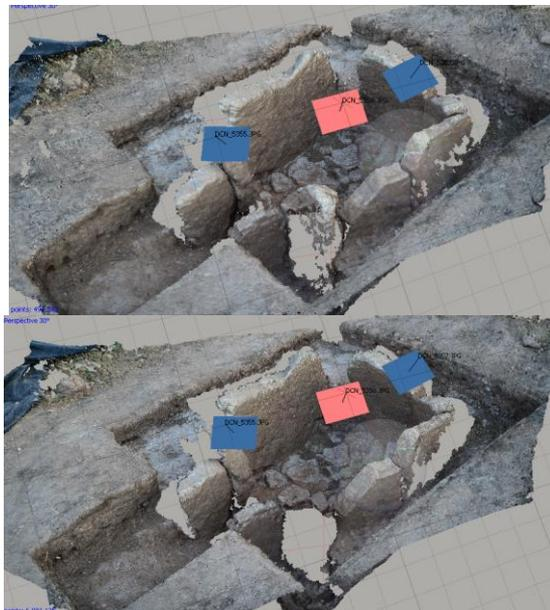
Modelo 3D de la nube densa a partir de 3 imágenes. Para un ajuste de densidad baja se han generado 494542 puntos (arriba). Para un ajuste alto se han generado 6984125 puntos (abajo). (J.A.Benavides)
