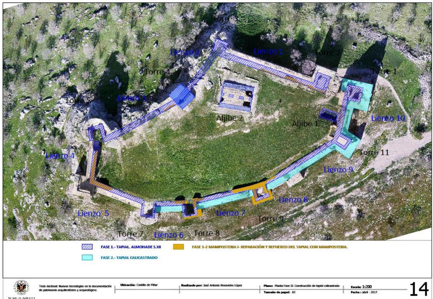
Plano de hipótesis constructiva fase I (tapial de tierra) y I-bis (reparación de muros con mampostería) y fase II (tapial calicastro)
