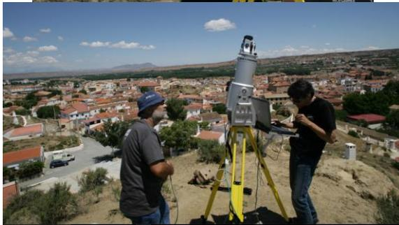
Escaneado desde *cerro Magdalena* mediante equipo Riegl LMS-Z420i. Escáner de “Tiempo de Vuelo” con un alcance efectivo de 700 m.
