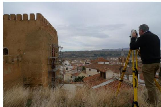
Medición de los puntos de control (dianas) mediante apoyo topográfico con Estación Total.
