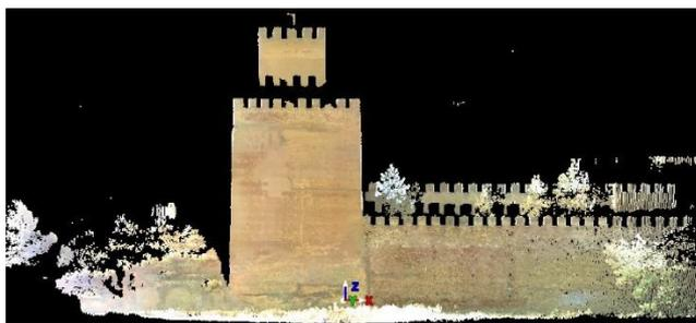
Visualización de nube de puntos texturizada a partir de las imágenes capturadas por la cámara interna. Escáner Scan Station2-Leica. (J.A.Benavides)
