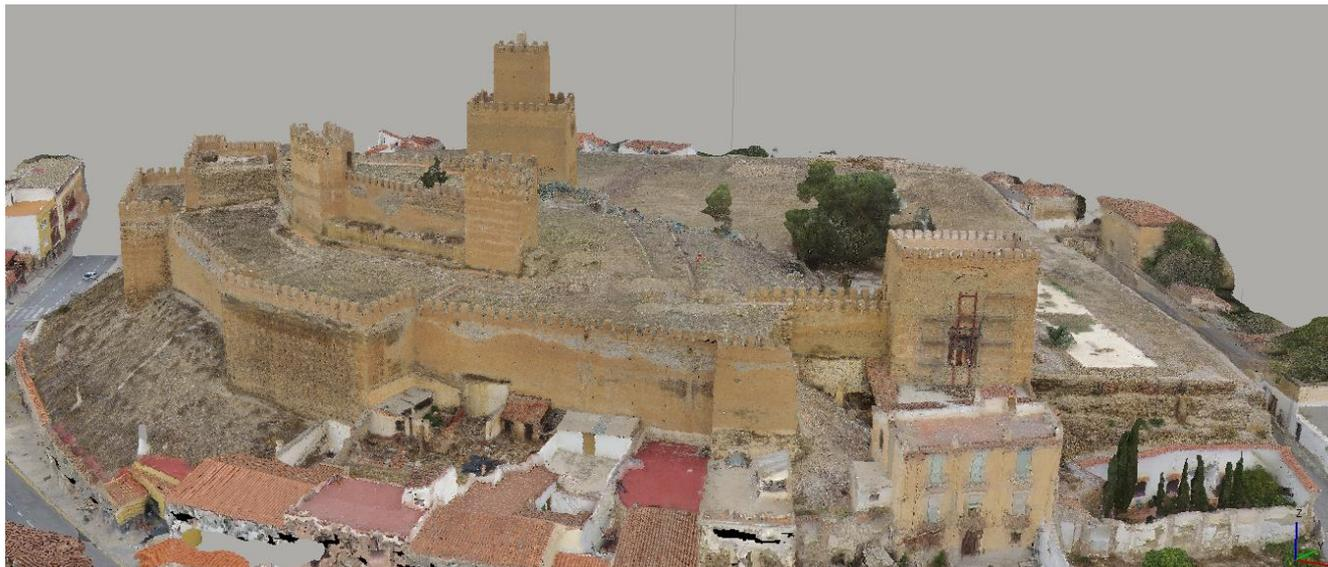
Vista en perspectiva de la malla con textura realista. La textura aplicada a cada una de las caras del triángulo se realiza mediante la aplicación directa de partes de imágenes sobre la malla. El resultado óptimo se realiza a partir de imágenes ortogonales al elemento a documentar. .(J.A.Benavides)
