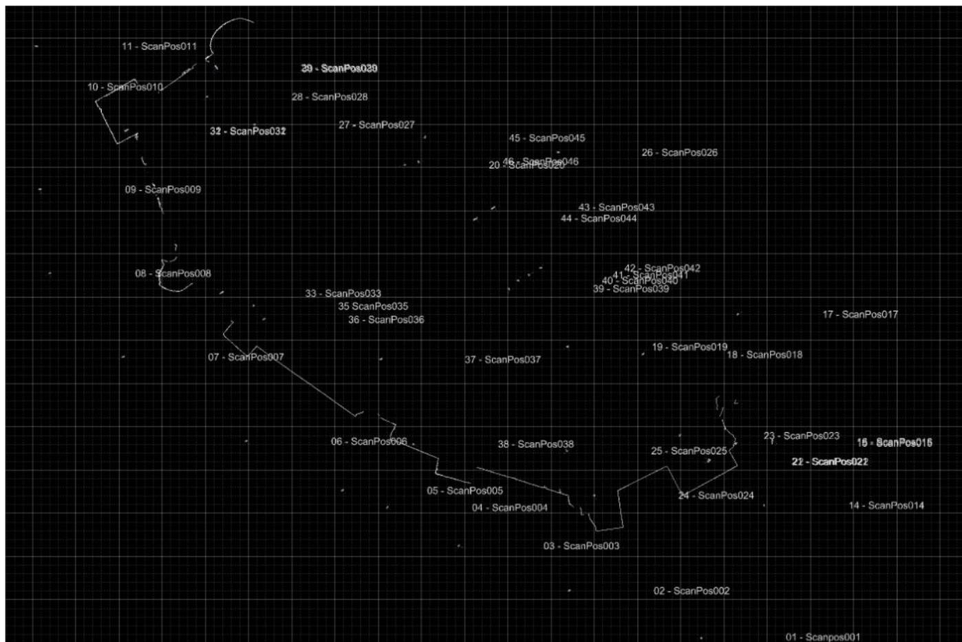
Localización de la posición de los escáneres en planta. Todos los escáneres están situados en la proximidad de los paramentos, salvo uno situado a unos 400 m. Cuadrícula de 5m. (J.A. Benavides)
