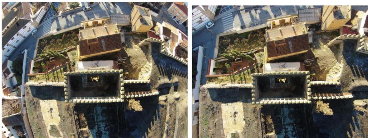
Imagen original con deformación tipo barrilete provocada por la lente ojo pez (izq.); imagen corregida en Photoshop CS6. (der). (J.A.Benavides)
