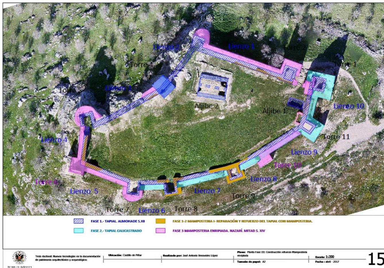
Plano de hipótesis constructiva fase I (tapial de tierra) y I-bis (reparación de muros con mampostería), fase II (tapial calicastro) y fase III (refuerzo de muros y torres con mampostería enripiada)
