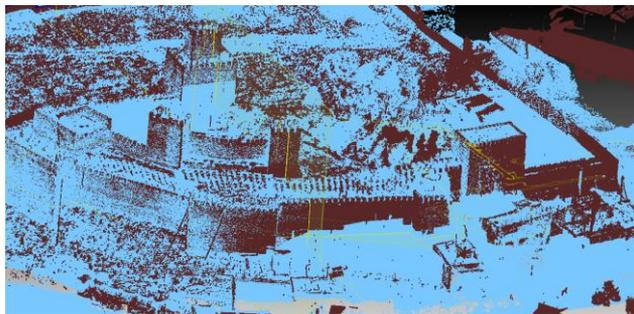
Imagen de la distribución no homogénea de puntos de escáner frente al registro completo realizado por fotogrametría SFM. En color cian se muestra el modelo 3D realizado mediante SFM, en tono marrón el realizado mediante escaneado laser. .(J.A.Benavides)
