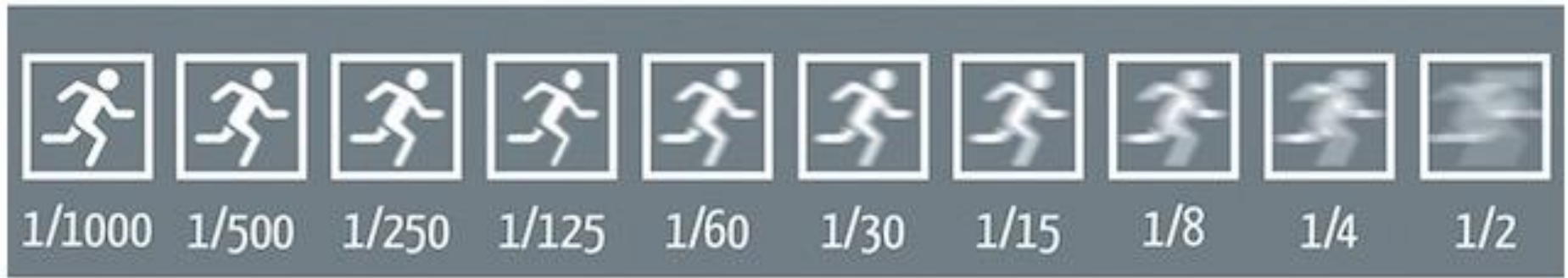
Fig. 31: Gráfico que muestra los resultados de la imagen al abrir o cerrar el obturador.
