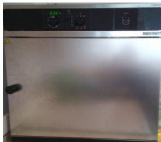
Figura 2.4. Estufa de incubación. Fuente: elaboración propia.
