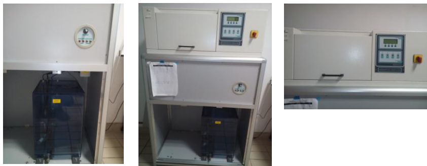
Figura 1.7. Cámara de envejecimiento. Fuente: elaboración propia.
