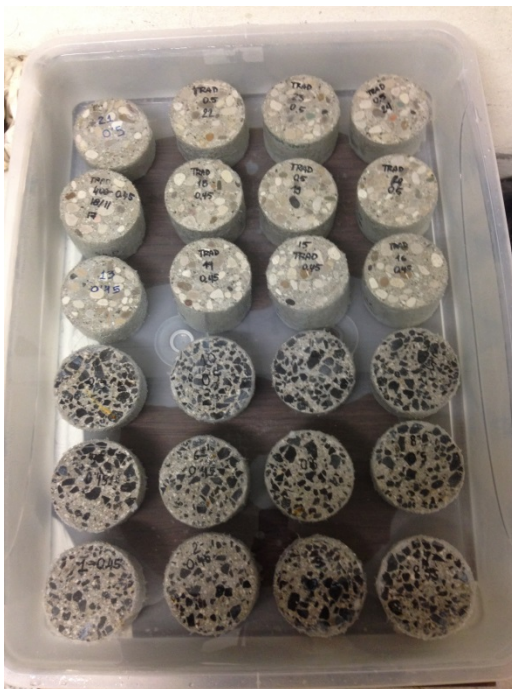
Figura 4.7: Probetas de hormigón sumergidas en la solución NaCl
