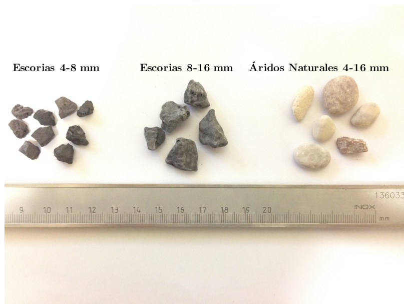
Figura 4.6: Aspecto de las escorias de acería de horno de arco eléctrico comparado con el de los áridos naturales utilizados
