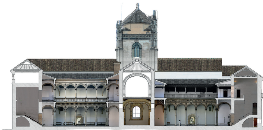
fig. 6.19 Fotoplano y sección longitudinal sobre los patios de los Mármoles y de la Capilla. Hospital Real de Granada.
