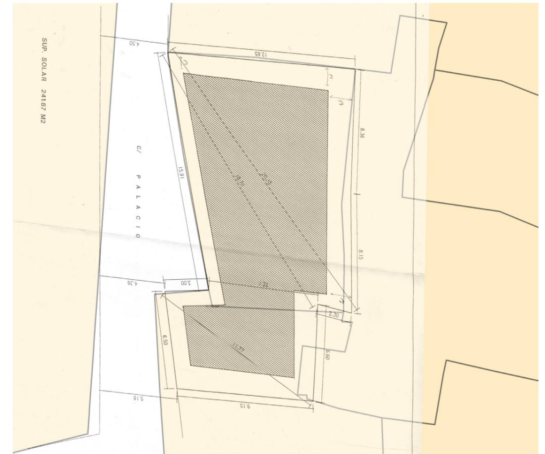
Imagen 21. Combinación de la planificación de los sondeos y el actual catastro.
