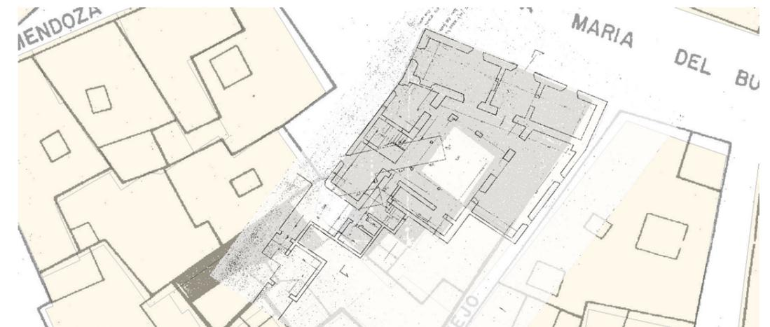
Imagen 11. Combinación de la planimetría del catastro actual, la planimetría del antiguo catastro y la planimetría estructural del edificio.
