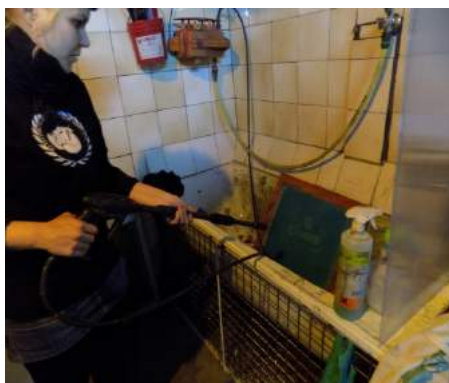
Fotografía 8. Eliminación de Emulsión¹
