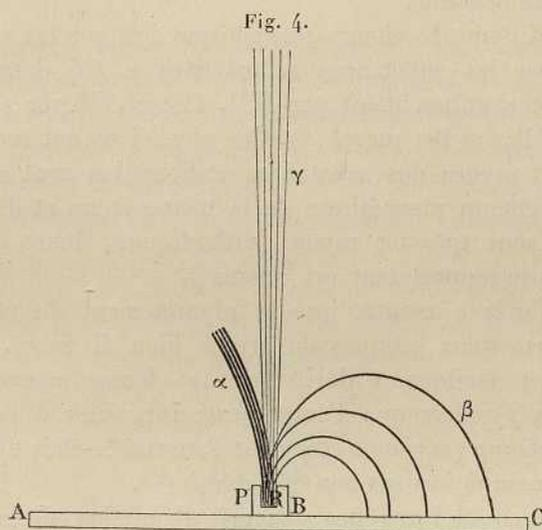
(0<sup>mm</sup>,1 d'épaisseur), les rayons  $\alpha$  sont en très grande partie supprimés, les rayons  $\beta$  le sont bien moins et les rayons  $\gamma$  ne semblent pas absorbés notablement.
