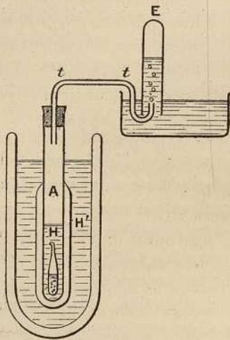
un gaz liquéfié et en mesurant le volume du gaz qui se dégage. On peut faire cette expérience avec du chlorure de méthyle (à  $-21^{\circ}$ ). L'expérience a été faite par MM. Dewar et Curie avec l'oxygène liquide (à  $-180^{\circ}$ ).
