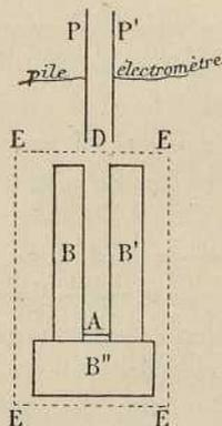
lonté établir le champ magnétique d'un électro-aimant normalement au plan de la figure dans toute la région EEEE. Si les rayons sont déviés, même faiblement, ils ne pénètrent plus entre les plateaux, et le courant est
