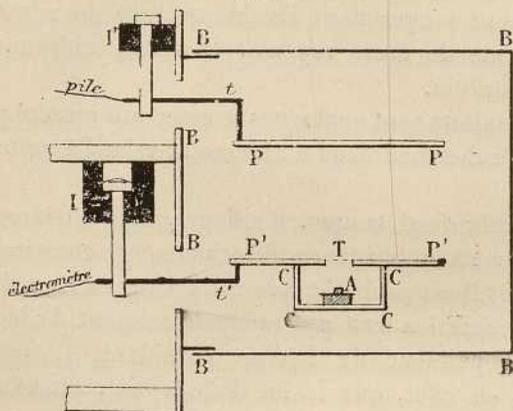
l'air du condensateur au travers d'une toile métallique T; les rayons qui traversent la toile sont seuls utilisés pour la production du courant, le champ électrique s'arrêtant à la toile. On peut faire varier la distance AT du corps actif à la toile. Le champ entre les plateaux est établi au moyen d'une pile; la me-
