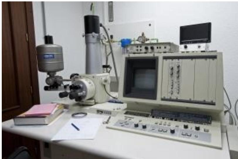
Fig.III.14. Microscopio Electrónico de Barrido Hitachi
