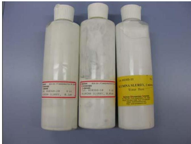
Fig.III.4. Partículas de aluminio utilizadas en el ultrapulido.
