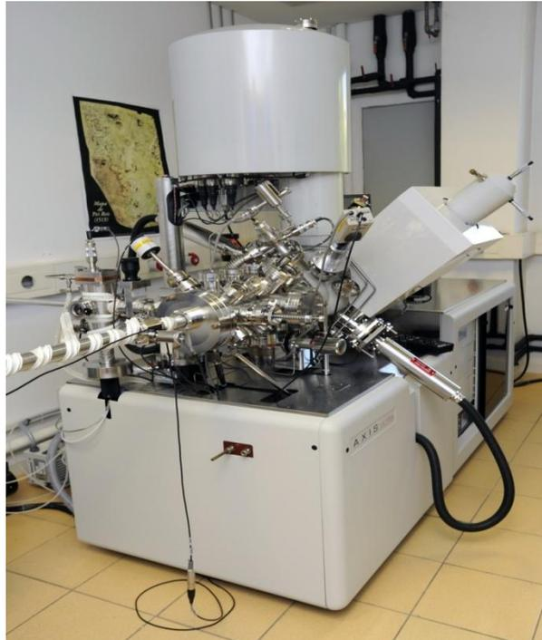
Fig.III.17. Espectrómetro de Fotoelectrones de Rayos-X Kratos Axis Ultra-DLD
