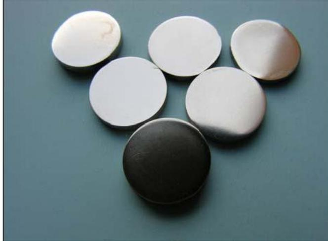
Fig.III.5. Discos de titanio después el ultrapulido
