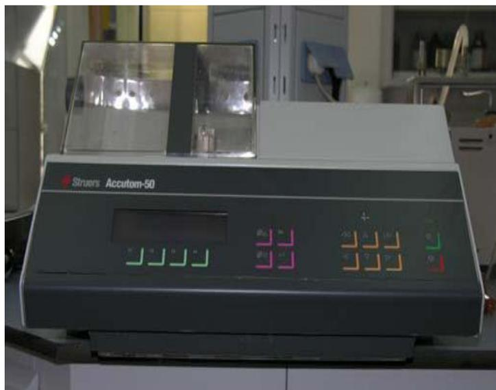
Fig.III.2.Micromoto Accutom utilizado para cortar las barras del titanio
