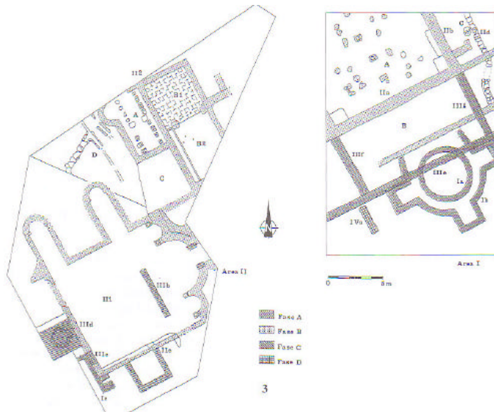
Fig. 29: Planta de las cuatro fases constructivas de la villa de El Saucedo (según Castelo, López, Torrecilla y Panizo, 2000) 1447 .
