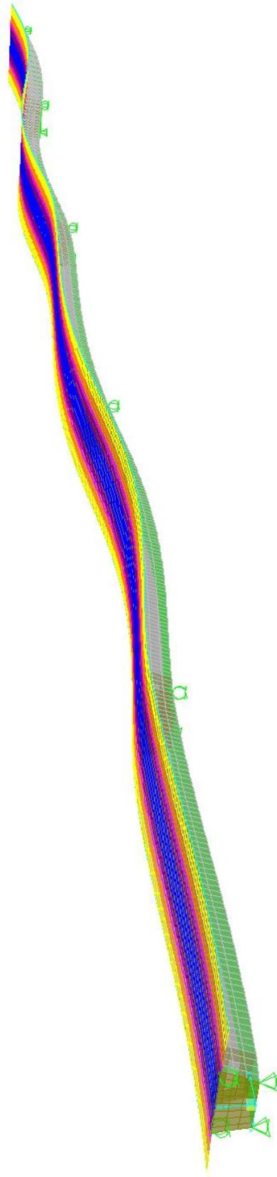
Figura 4.3: Tercer modo de vibración (3.2638 Hz).
