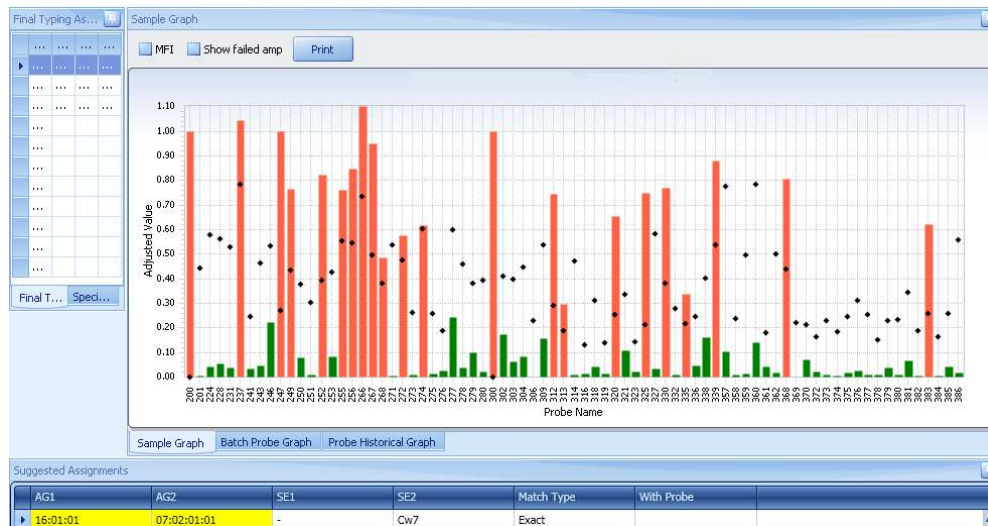
Figura 18. Tipaje HLA utilizando el programa informático Match it. En el eje de abscisas se muestran las diferentes microesferas o beads de ese locus en concreto y en el eje de ordenadas la fluorescencia observada asociada a cada microesfera. Analizando el patrón de fluorescencia en las diferentes beads el programa informa un tipaje ( HLA-C*16:01, C*07:02 en este ejemplo)
