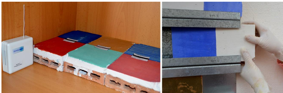
Figura 5. Izquierda. Control de las probetas conservadas en laboratorio. Derecha. Retirada de las probetas tras el ciclo de envejecimiento exterior.
