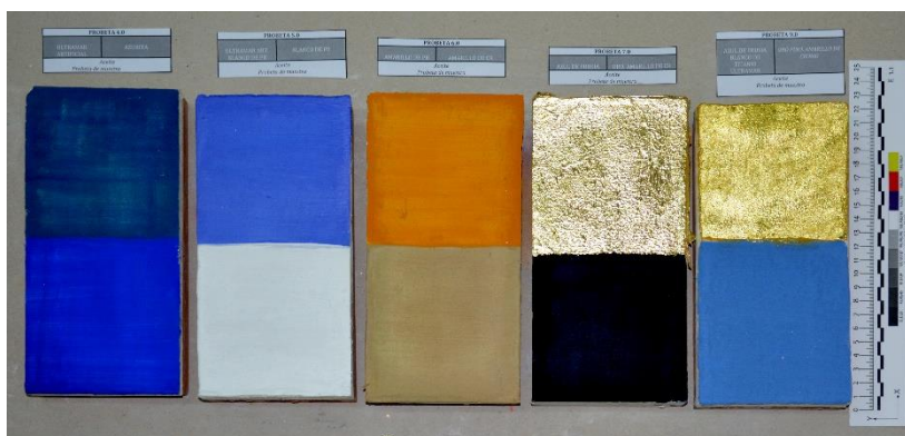
Figura 170. Imagen general de las probetas identificativas de los materiales modernos una vez policromadas.
