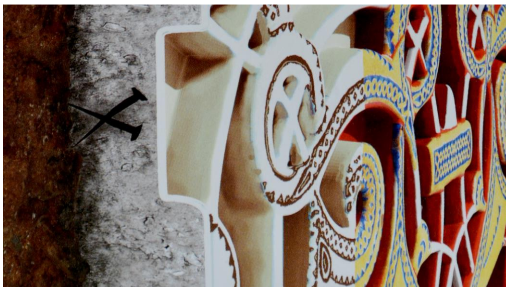
Figura 91. Imagen virtual de una placa de yeso vista de perfil en la que se observan los clavos colocados para favorecer su adhesión al muro, la capa de preparación o base para la aplicación de la policromía y la policromía efectuada. Extraída de (Rubio Domene, 2010, p.217).
