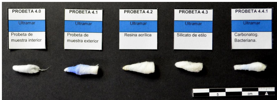
Figura 215. Serie de acabados cromáticos realizada con el pigmento azul ultramar artificial aglutinada con aceite en el que se demuestra la efectividad de los tratamientos aplicados.
