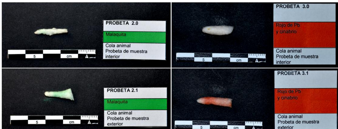
Figura 214. Comparación de la prueba de solubilidad realizada a dos acabados cromáticos realizados con cola animal, conservadas en el laboratorio y expuestas al exterior durante el ciclo de envejecimiento.
