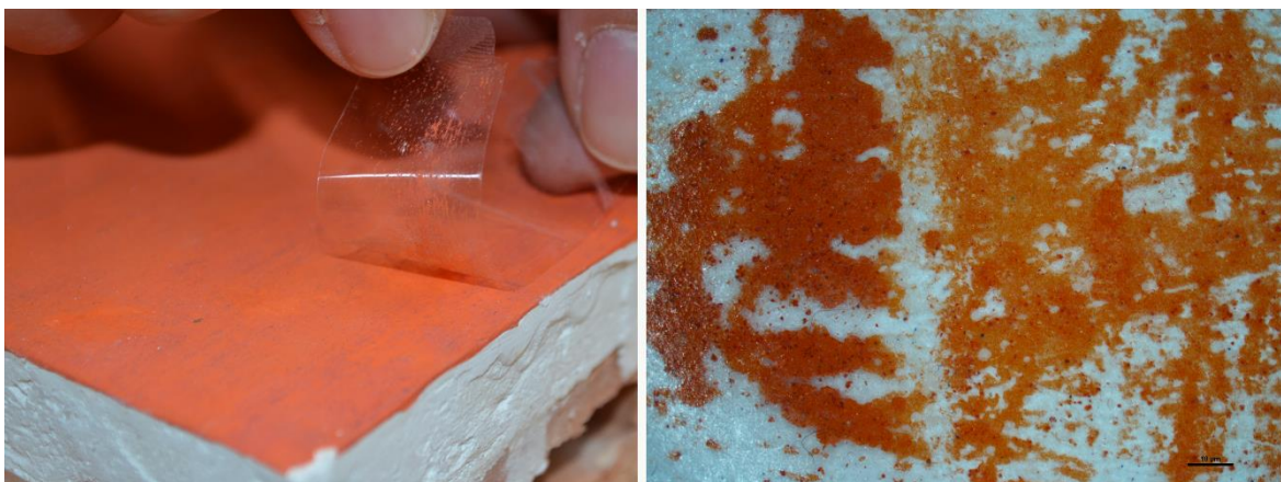
Figura 10. Forma de aplicación del método de la "spugna di contatto". Izquierda. Impregnación de la esponja con la cantidad de agua destilada determinada. Derecha. Aplicación de la esponja sobre la superficie.
