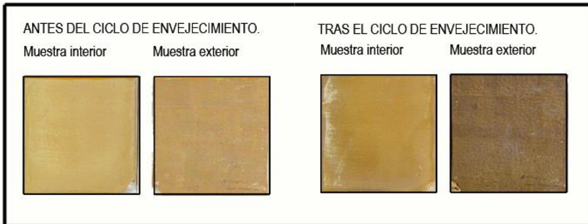
Figura 201. Detalle del acabado cromático de amarillo de plomo antes y después del envejecimiento en las muestras sin tratar en las cuales se denota el evidente oscurecimiento que sufre el patrón sin tratar exterior.
