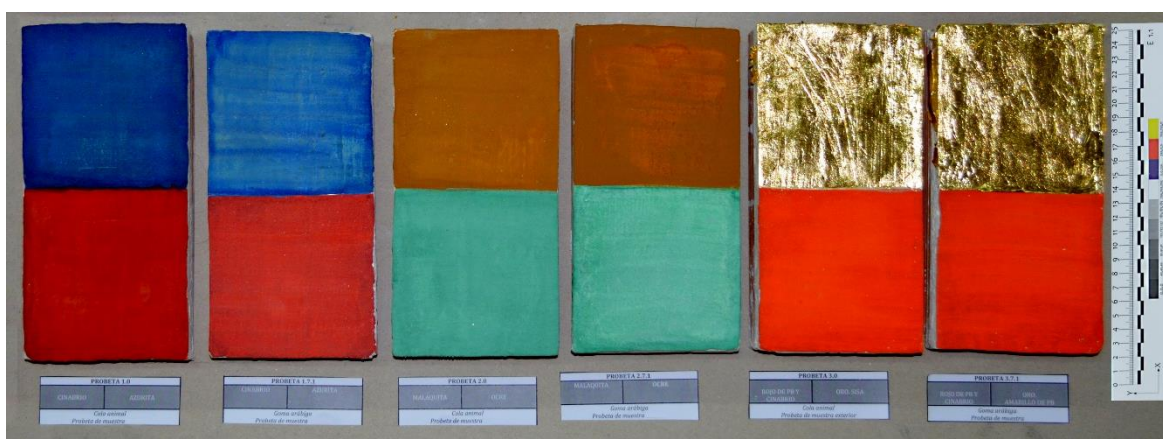
Figura 4. Imagen de algunas de las probetas identificativas de los materiales históricos sometidas a ensayo. En ella puede observarse la aplicación de dos acabados cromáticos por probeta de yeso.
