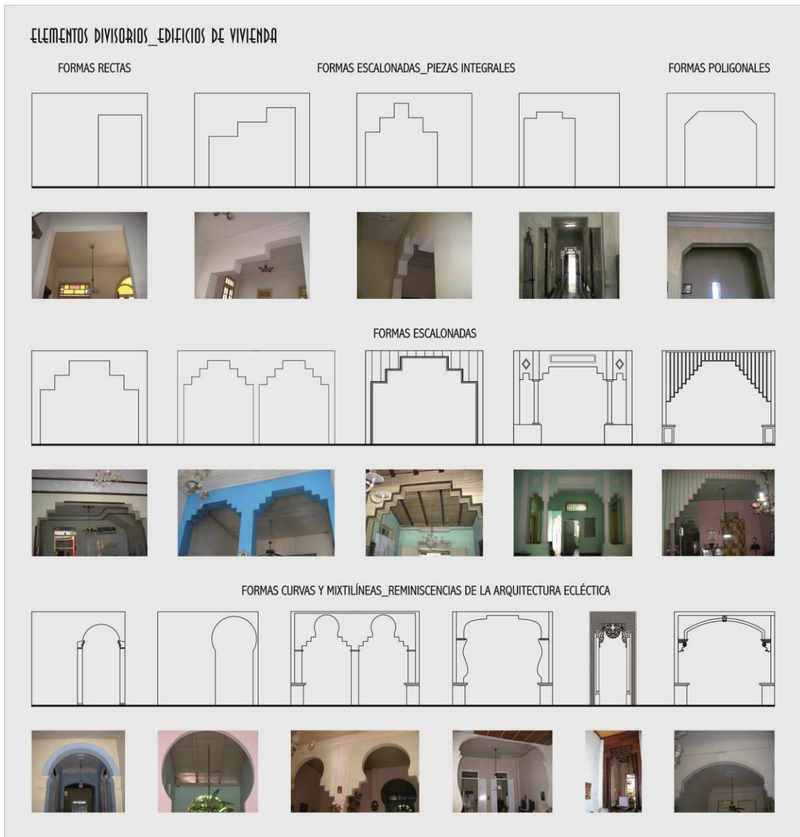
Figura 3.57.- Elementos divisorios en los ambientes interiores de las viviendas Art Decó. Primera etapa (1930-1939/42)
