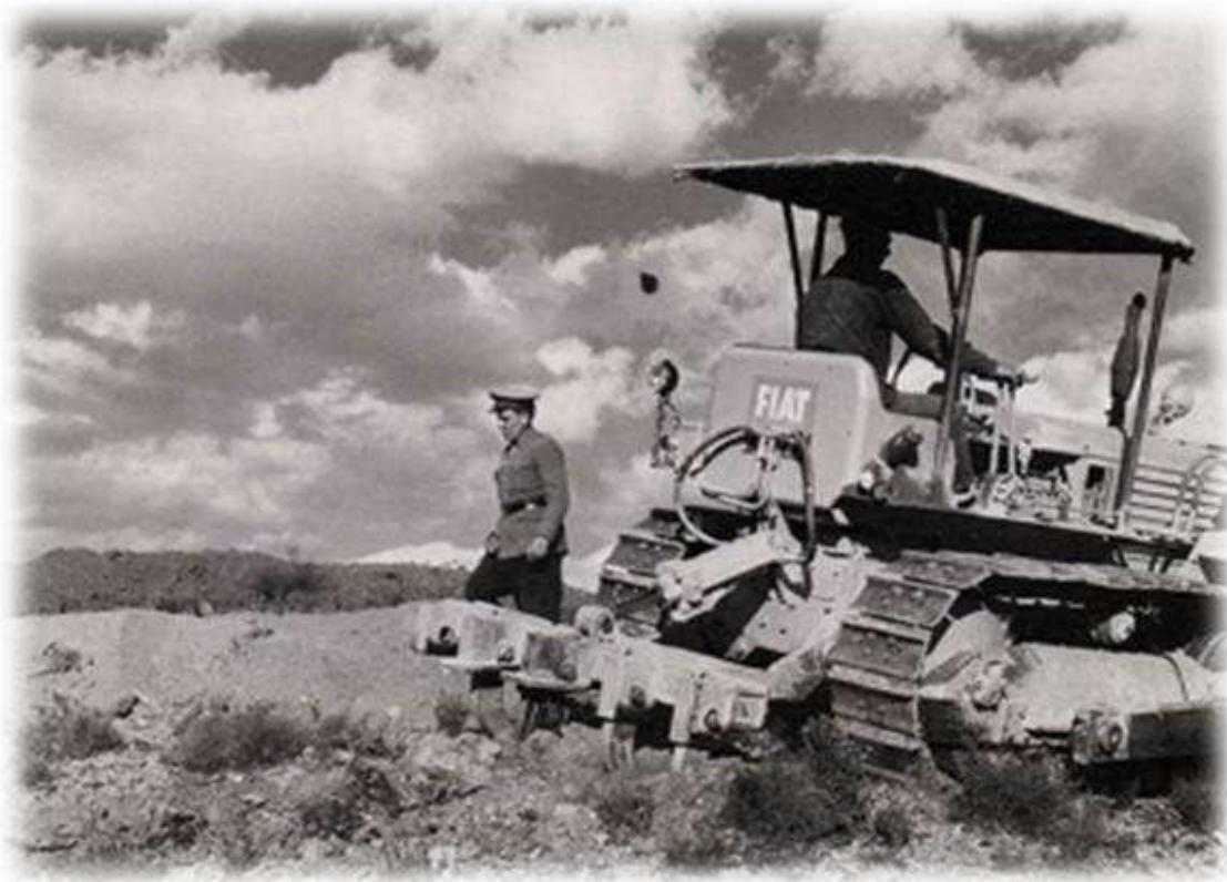
Imagen 91: Tractor de cadenas utilizado en repoblaciones para aterrazamientos en los años 70
