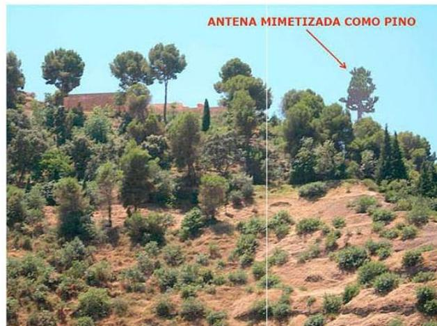
Ilustración 12. Silla del Moro, con antena de reemisor mimetizada en soporte en forma de pino de 12 m.
