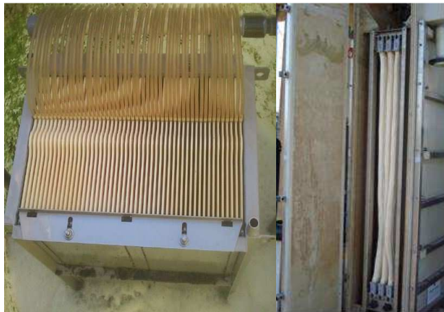
Figura 1.1. Ejemplos de sistemas MBR de configuración inmersa.
