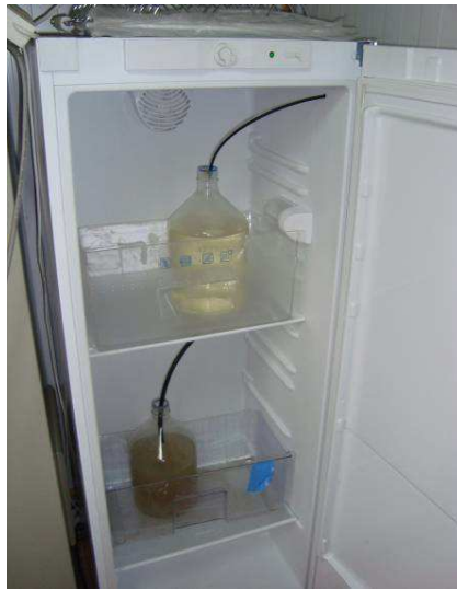
Figura 3.6. Frigorífico empleado para toma de muestra y frascos de acumulación.
