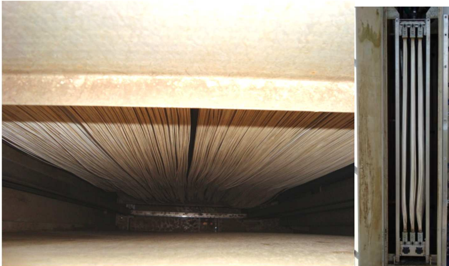
Figura 3.5. Módulo de membranas de ultrafiltración MBR-UF.
