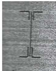
Figura 103. Croquis de conformación de perfil en doble T usando acero laminado y escuadras. Fuente: (Anónimo, 1909).
