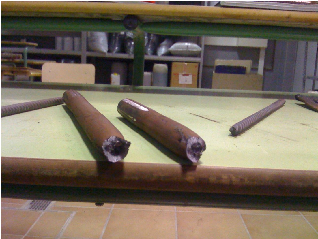
Figura 154. Sección de la muestra 2 tras el ensayo de rotura. Fuente: Elaboración propia.
