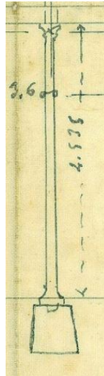
Figura 56. Ampliación de plano original de columna de fundición con cimentación aislada en la Fábrica Nuestra Señora del Pilar. Fuente: Colección privada M. Giménez Yanguas.
