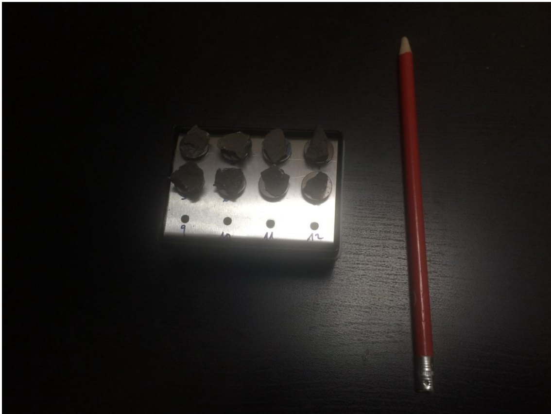
Figura 146. Preparación de las cuatro muestras, separando pequeños fragmentos representativos para analizar mediante difracción de rayos X. Fuente: Elaboración propia.
