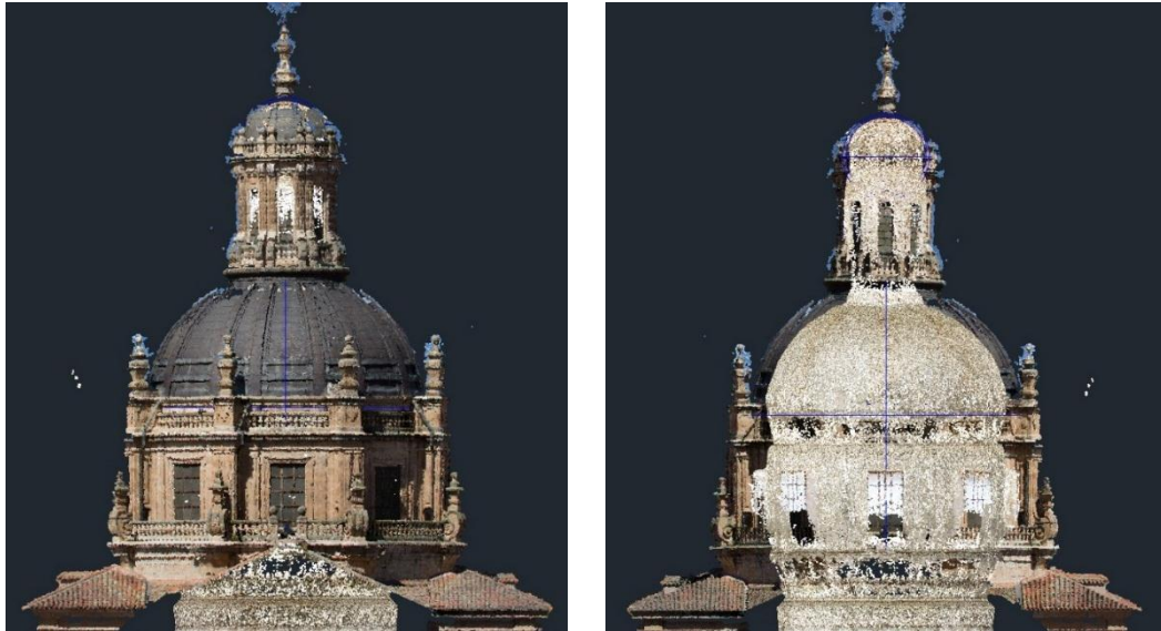
Ilustración 56 y 57- Composición de nubes de puntos interior y exterior. Vista alzado Este y sección. Elaboración propia.
