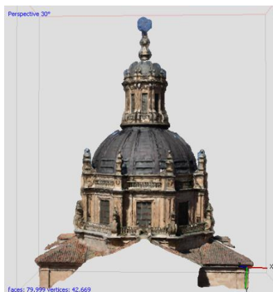
Ilustración 51- Arriba, vista de las posiciones y orientación de cámara. Abajo, imágenes del proceso de elaboración del escaneo 3D del exterior de la cúpula mediante agisoft Photoscan.
