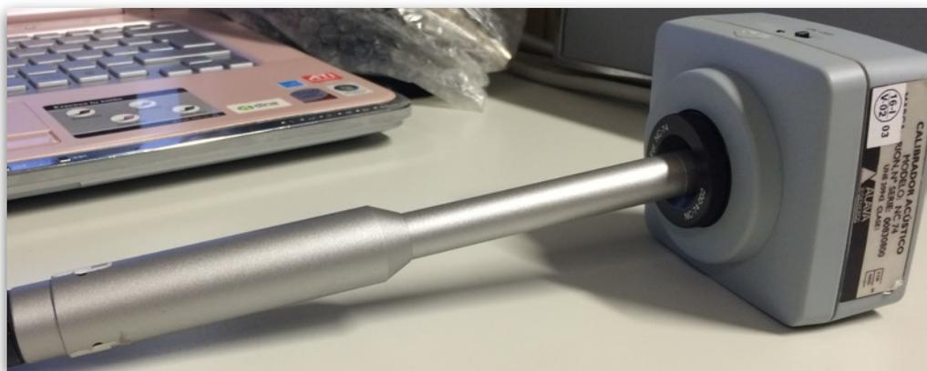
IMAGEN 3.4.6. *Micrófono con calibrador.*
