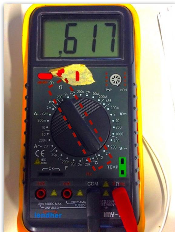
IMAGEN 3.2.2. Valor voltímetro y posición dos voltios y corriente alterna.
