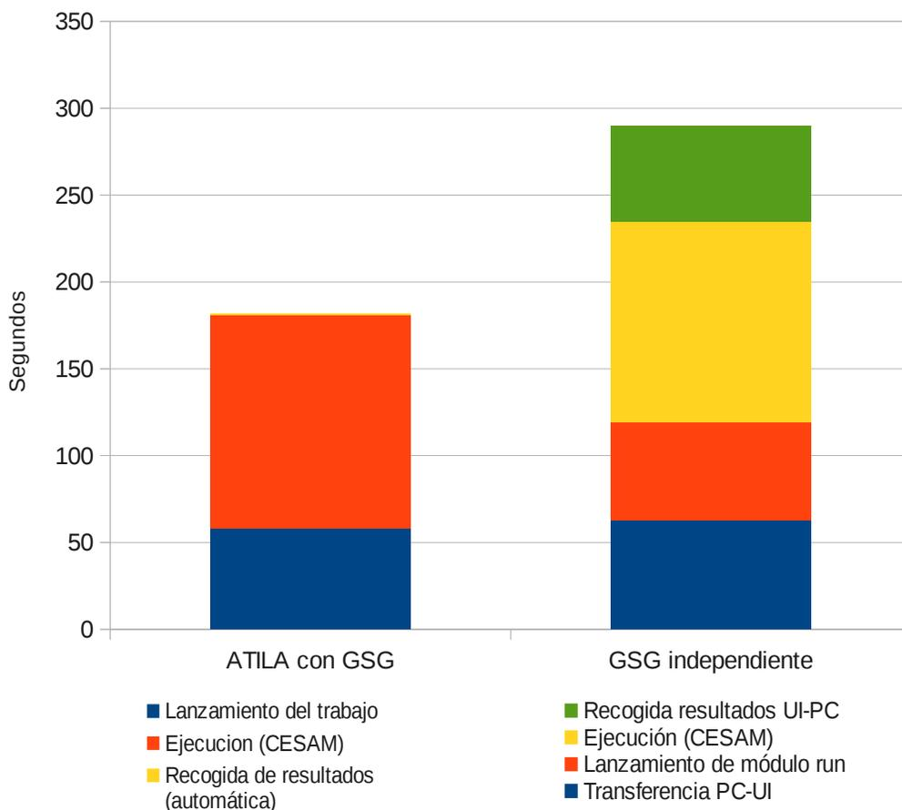
Figura 4.12: Ejecución simple, que lanza un trabajo de la aplicación Cesam al entorno Grid mediante ATILA con GSG frente a GSG independiente.
