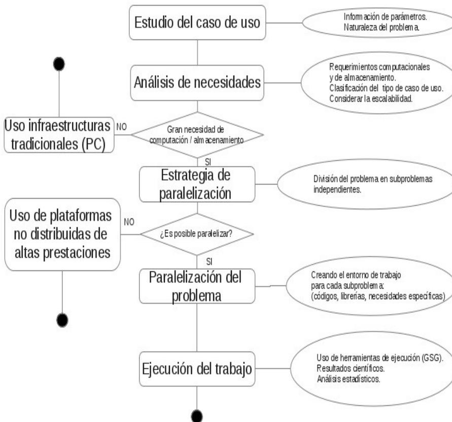
Figura 2.3: Diagrama de flujo de la metodología propuesta para la adaptación de aplicaciones a entornos distribuidos.
