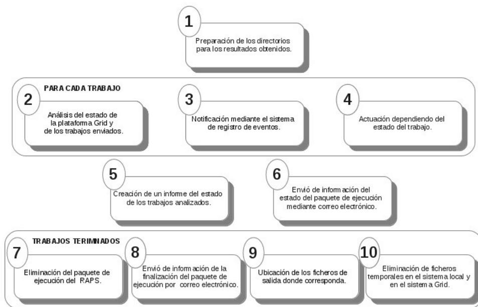
Figura 3.6: Funciones de la herramienta GSG verify.
