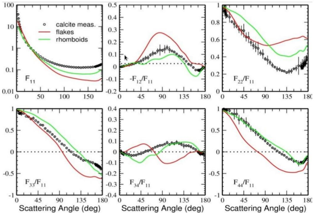
Figura 2.23: Simulaciones de dispersión frente al análisis experimental de calcita a 647 nm. Muestra de partículas de calcita para geometrías de romboide y escamas. Figura obtenida de [DAB14]
