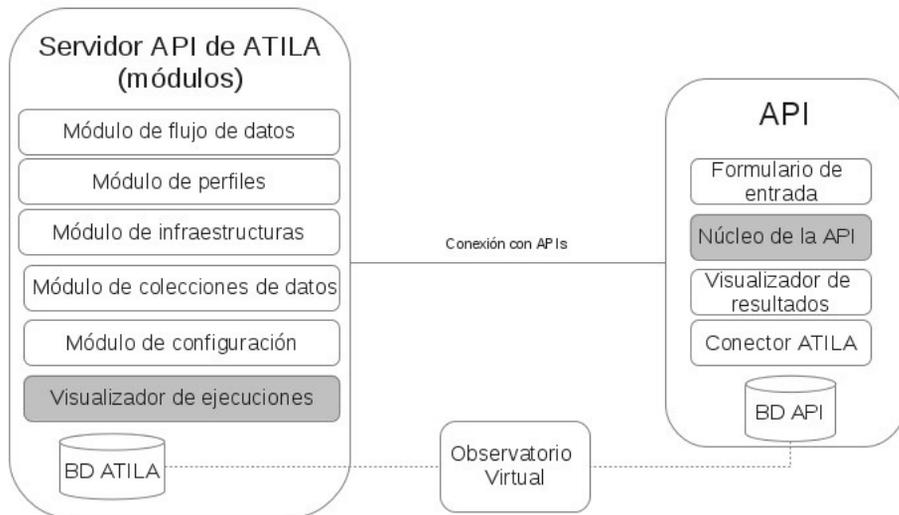
Figura 4.2: Composición modular del servidor de aplicaciones ATILA
