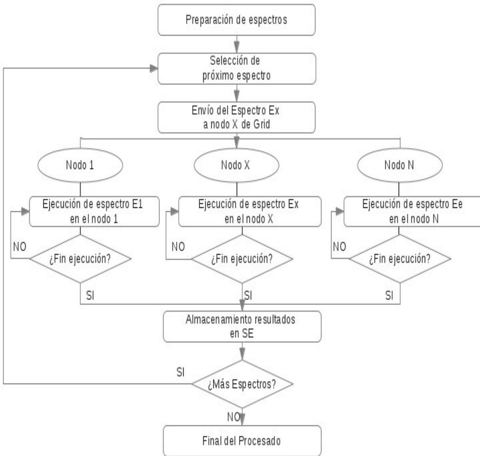
Figura 2.11: Diagrama de flujo del procedimiento de asignación de un espectro a un trabajo Grid.
