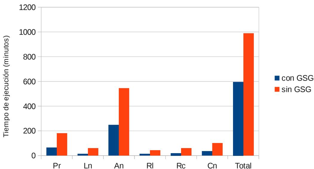
Figura 3.16: Diagrama de barras de la comparación de tiempos en las distintas fases de una pila de trabajos mandados a una plataforma Grid, excluido el tiempo de ejecución.
