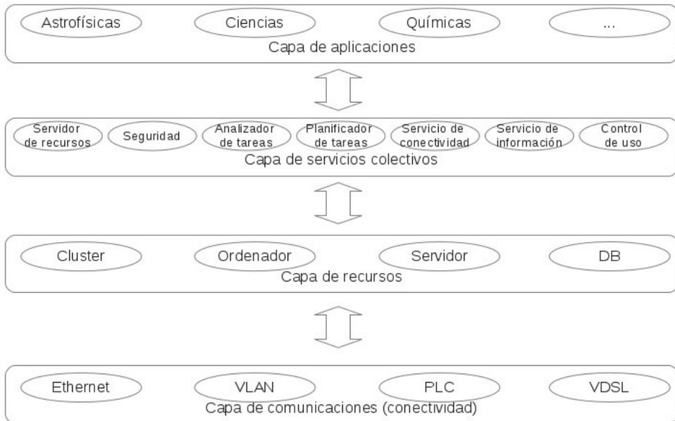
Figura 1.6: Capas de una infraestructura Grid.
