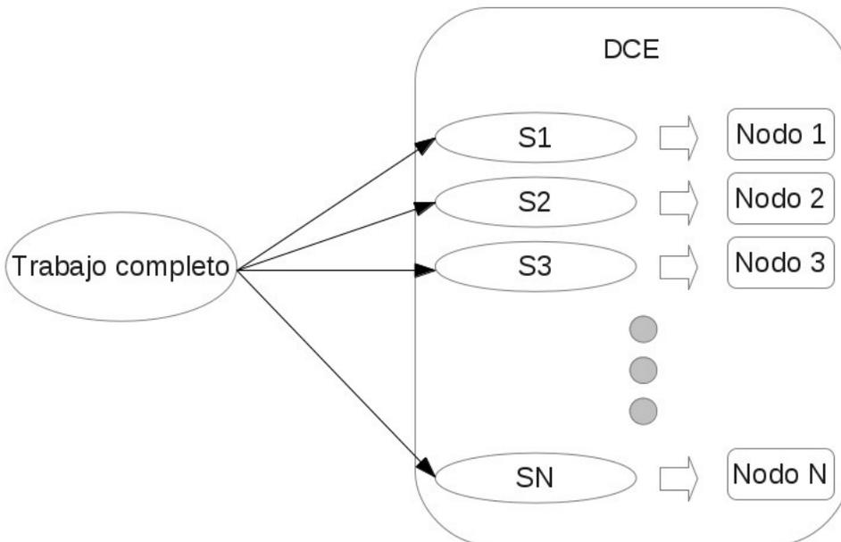
Figura 2.1: Distribución de carga del trabajo en un entorno distribuido.  $S1...SN$  son los subtrabajos enviados a cada uno de los los nodos de computación. DCE: Entornos distribuidos (Grid, Cluster, Cloud)
