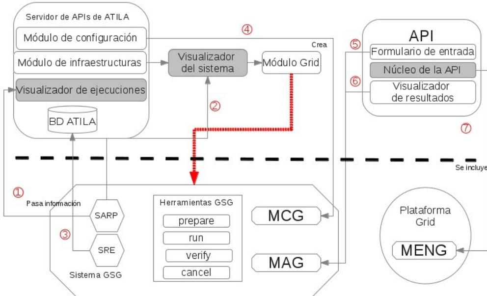
Figura 4.6: Conexión del módulo Grid de ATILA con GSG
