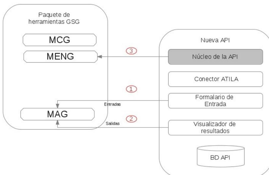
Figura 4.8: Instalación de nueva API en el servidor de aplicaciones ATILA. Proceso de conexión entre el sistema AA y el sistema GSG.
