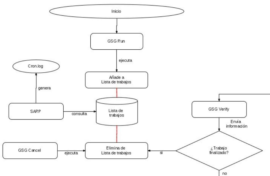
Figura 3.12: Funcionamiento del Sistema de Administración Regular de Procesos.
