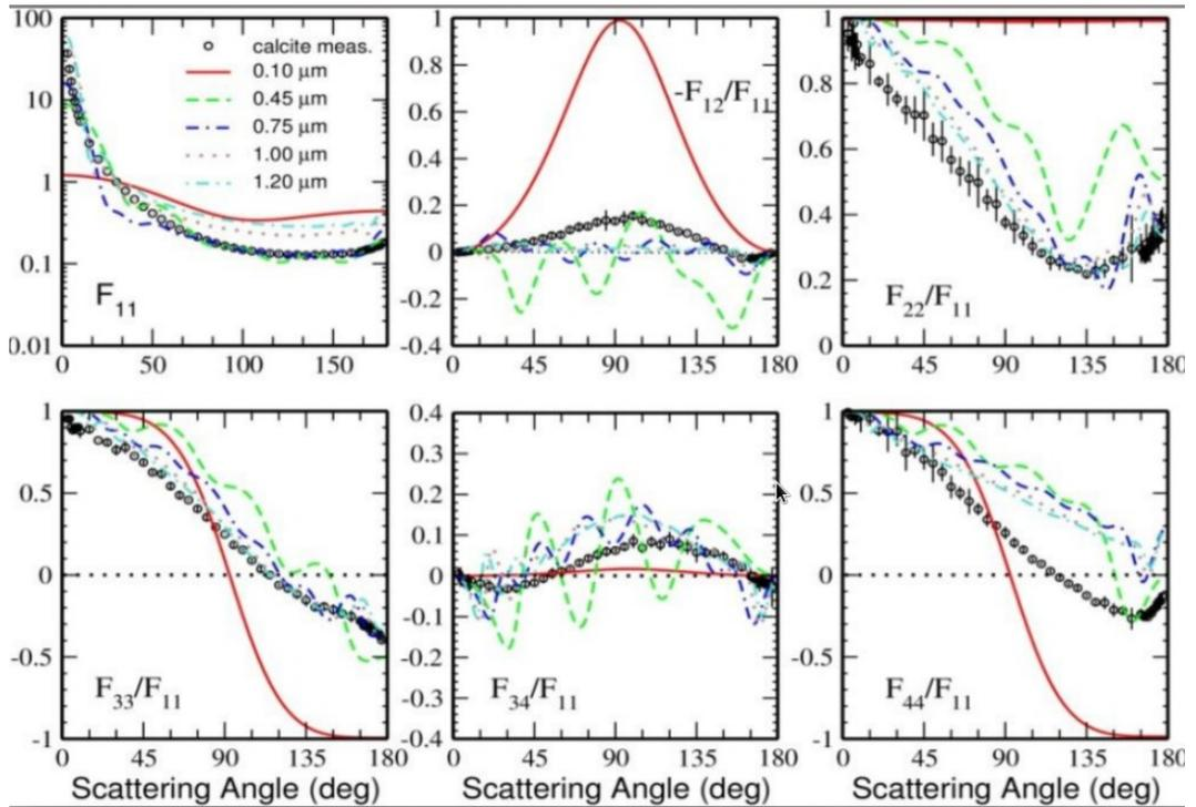
Figura 2.22: Simulaciones de dispersión frente al análisis experimental de calcita a 647 nm Muestra de partículas de calcita para diferentes tamaños de la partícula. Figura obtenida de [DAB14]
