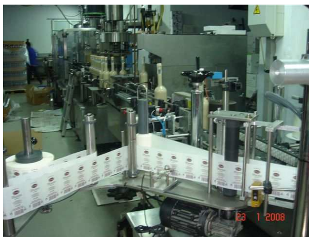
Figura 312. Proceso de etiquetado, en la empresa Destilerías Carthago . (2008).
