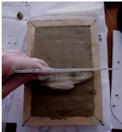
**Figura 28.** Alisado superficial de la probeta
