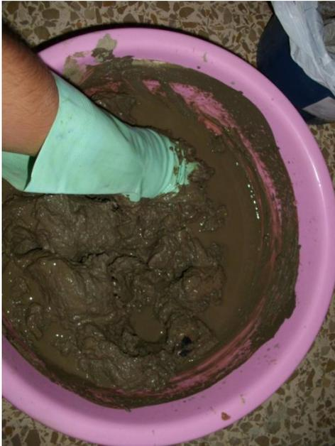
**Figura 21.** Mezclado manual de la arcilla en humectación
