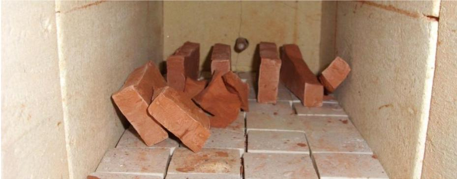
**Figura 37.** Rotura de las muestras Dr1 y Dr2 durante la cocción a 850 °C
