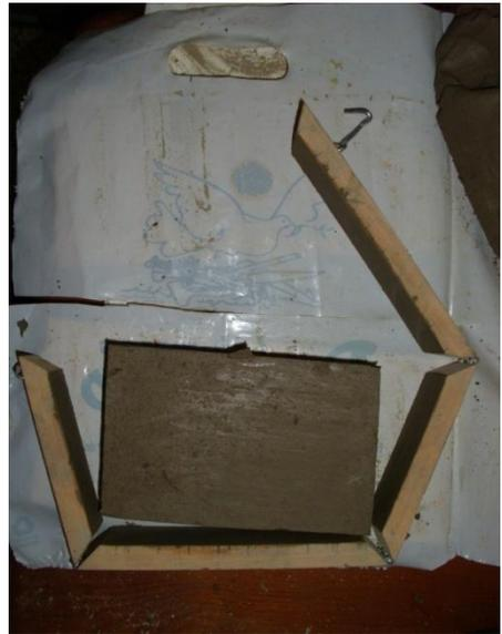
**Figura 30.** Extracción del molde
