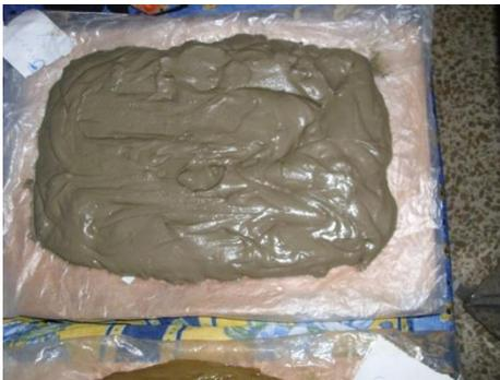
**Figura 23.** Reposado al aire de la arcilla
