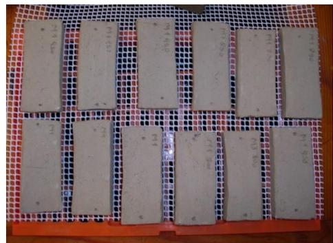
**Figura 34.** Secado de las probetas sobre una rejilla
