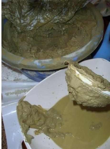
**Figura 22.** Cribado de la arcilla por tamiz con luz de 600  $\mu\text{m}$
