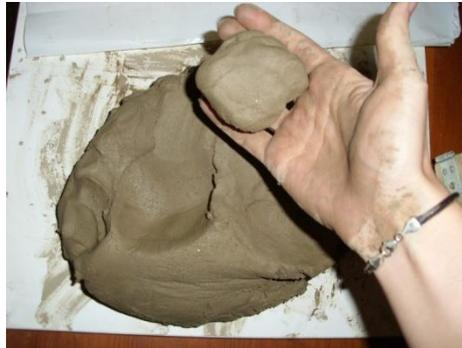
**Figura 24.** Textura de la arcilla con humedad óptima
