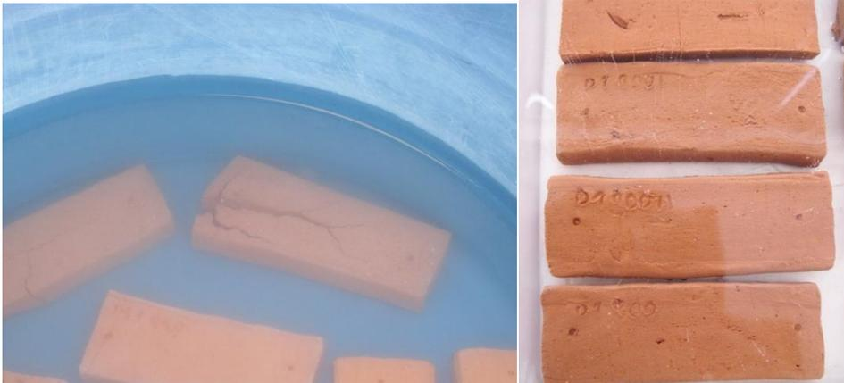
**Figuras 40 y 41.** Rotura tras la inmersión de las muestras cocidas F (nótese el aspecto turbio del agua), y aspecto cristalino del agua donde se sumergieron las piezas cocidas de D1, respectivamente.
