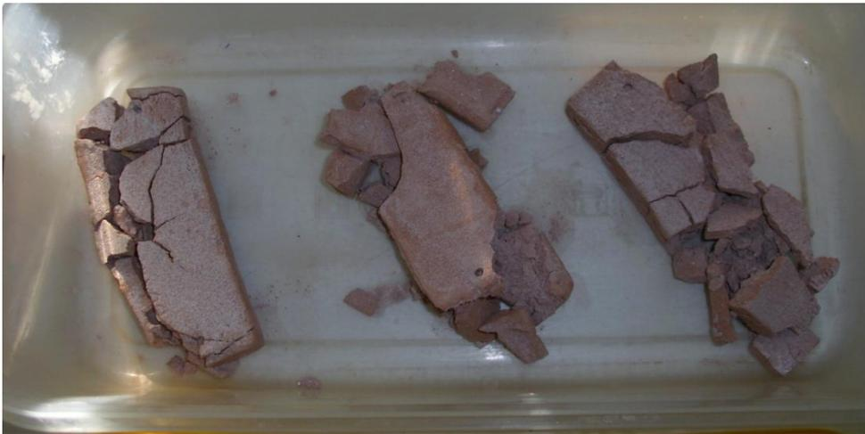
**Figura 42.** Aspecto de las muestras de F850 I, F850 II y F850 III tras su rotura.
