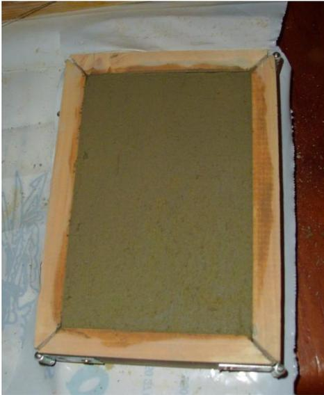
**Figura 29.** Primer secado dentro en el molde
