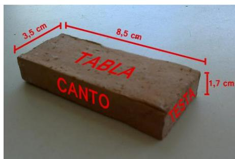
**Figura 35.** Conformación de las probetas y designación de sus superficies
