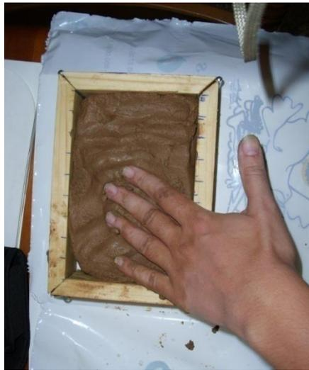
**Figura 26.** Relleno por presión del molde
