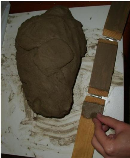
**Figura 25.** Aplicación de barbotina en el molde
