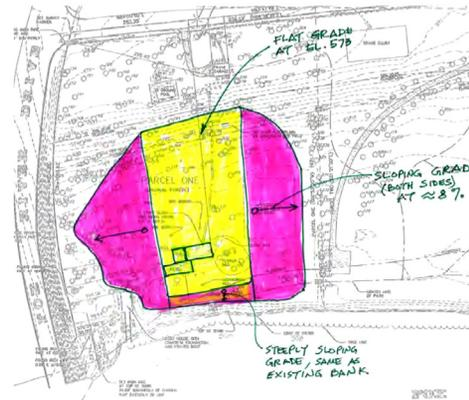
[Figura capI 43-44] Planos de movimiento de tierras producido para elevar la cota de suelo y desplazar la casa y rasante de la Villa Farnsworth sin modificar la posición en planta.
