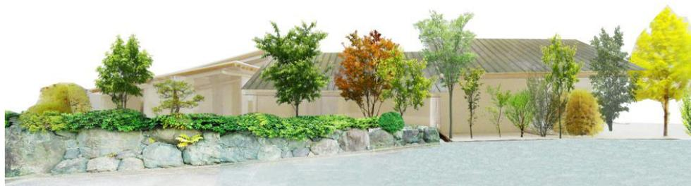
El zócalo de tierra recompone la ladera para ser habitada, haciendo de mediador entre el estrato original y la nueva cota en la que se asientan las viviendas. Ayudado por la vegetación, la tierra contenida entre los muros de piedra a junta seca, absorbe el agua de lluvia que drenará paulatinamente.
