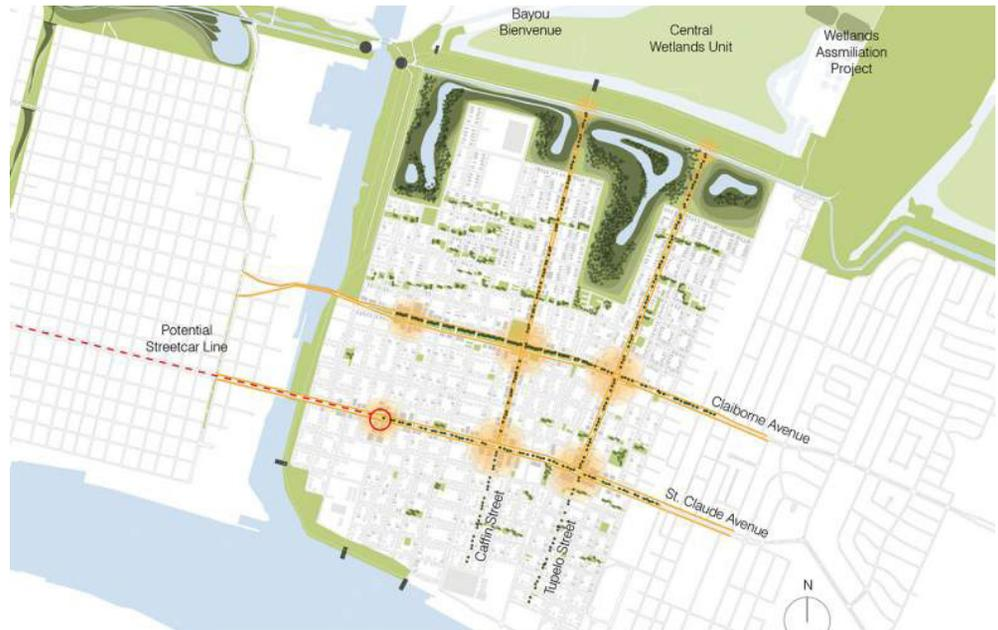
[Figura capI 148] Plano de los canales trazados en las calles y las balsas de acumulación y retención.
