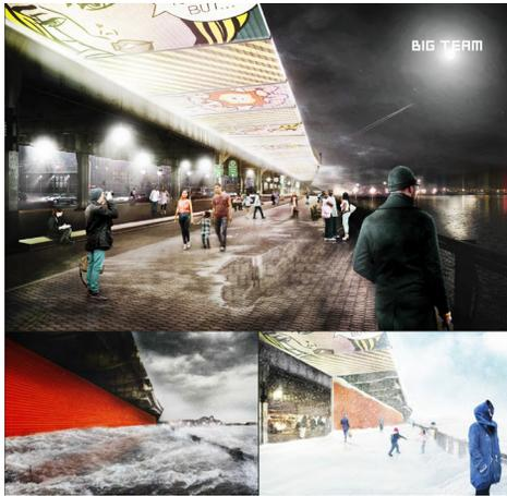
[Figura capII 51] Vistas de las pantallas plegables sobre el puente que se abatirán a modo de compuertas estancas en caso de previsión de catástrofes.
