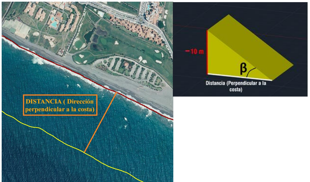
FIGURA 47: DISTANCIA ENTRE LÍNEAS DE BATIMETRÍA PARA EL CÁLCULO DE RUN UP, Y CONCEPTO DE LA PENDIENTE EN NUESTRO ÁMBITO
