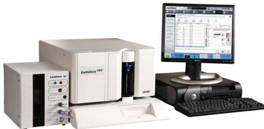
Las condiciones del equipo fueron las indicadas por el protocolo del kit y fueron las siguientes: Events: 50 por microesfera; Sample Size: 50 µl; Gate Settings: 8.000 a 15.000; Reporter Gain: default (low PMT); Time Out: 60 seconds; Bead Set: OPG/61; OC/63; leptina/39, OPN/64; PTH/74; ACTH/12; Insulina/36; IL-6/34; TNF-α/55.
