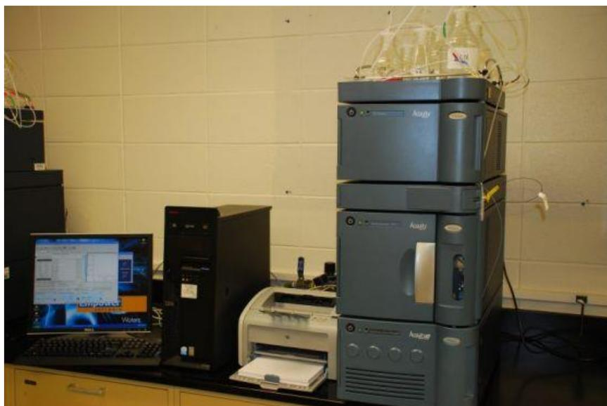
La separación cromatográfica fue llevada a cabo usando un gradiente isocrático con fase móvil de metanol al 0.1% (v/v) de ácido fórmico. Con un flujo de 600 µl /min, la columna fue mantenida a 40°C y la inyección de volumen fue de 10 µl. La columna utilizada fue una Acquity UPLC BEH C18 1.7 µm, 2.1 x 100 mm (Waters Corporation, Milford, USA).
