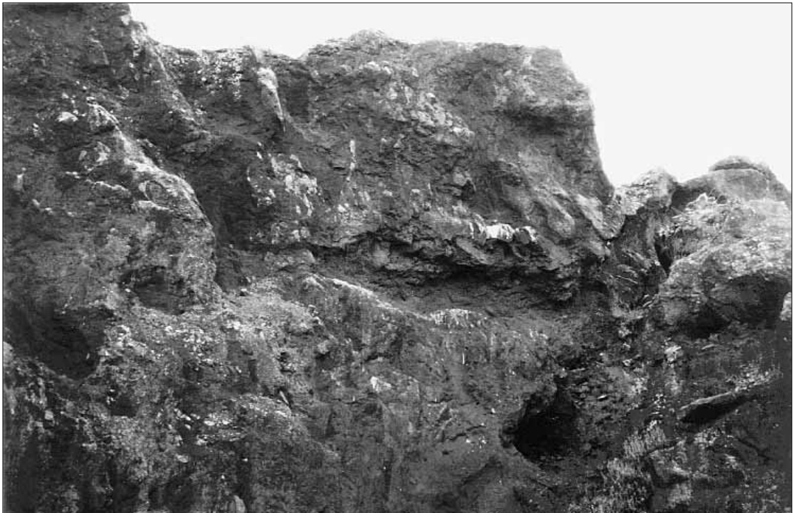
Fig. 10. Minas de la ladera NE. Las explotaciones a cielo abierto rompen las galerías antiguas de formas irregulares que quedan colgadas en el perfil.
