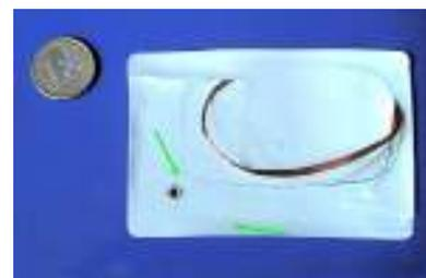
Comparación de un chip RFID con antena y una moneda de un Euro<sup>6</sup>
