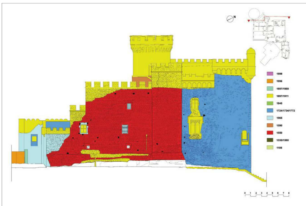
IDENTIFICACIÓN DE HORIZONTES CRONOLÓGICOS EN EL ALZADO NORTE DEL CASTILLO DE CASTELLDEFELS. ALBERTO LÓPEZ MULLOR. 90
