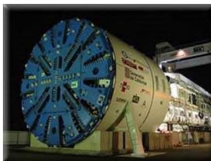
**Figura 2. Vista en perspectiva de una moderna tuneladora. Fuente: Alonso (2002)**
