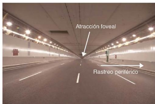
**Figura 9. Factores de sobrecarga mental en el interior de un túnel.**
