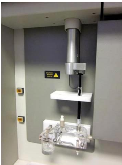
Figura 18. Imagen del bloque de metacrilato y jeringa de vidrio del ABI PRISM 310.
