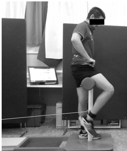
**Figura 9.** Colocación del sujeto durante la evaluación isocinética de la fuerza del cuádriceps con el sistema Haefni Health 1.0.
