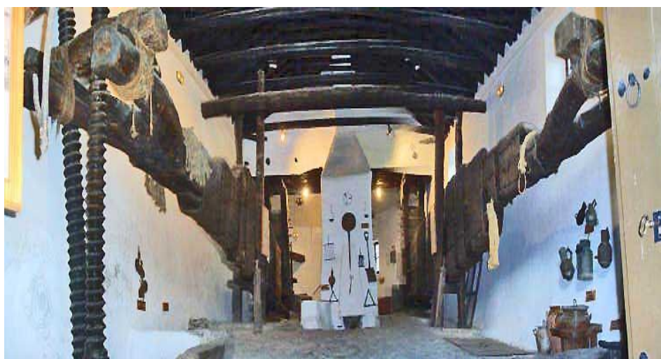
Ilustración 33: Vigas de prensado de la Almazara de las Laerillas de Nigüelas ( http://www.adurcal.com/mancomunidad/guia/niguelas/ruta/index.htm )
