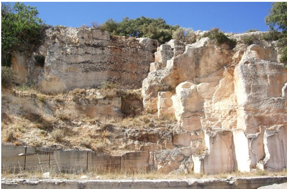
Ilustración 39: Cantera de piedra del Calar de la Iglesia, Padul. Cortes de la explotación moderna debajo de la antigua explotación
