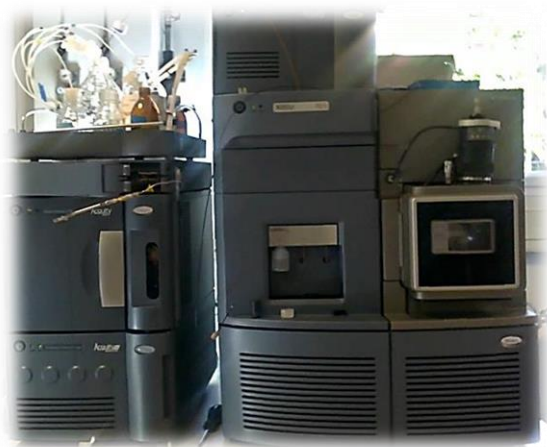
Figura 17. Espectrómetro de masas con analizador de triple cuadrupolo del centro de Instrumentación Científica de la Universidad de Granada.
