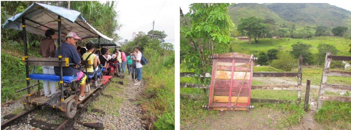
Figura No. 3-11: Sistemas de movilidad artesanal (mesa y moto-rodillos) usados sobre el corredor férreo. 2012. Fotografía del autor.
