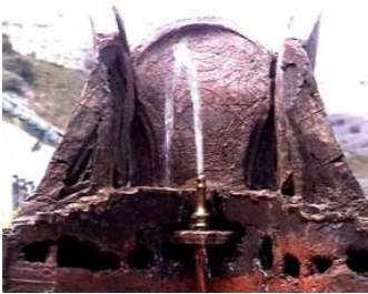
Img.6. 24 2000 05. Pruebas con agua tras la cocción. Tres de los cuatro módulos Vista del surtidor central de bronce, conectado a una manguera a través de un escudo de terracota.
