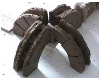
Img. 5. 27 1999 07 Dovelas de 3ª generación de radio grande antes de cocerse.
