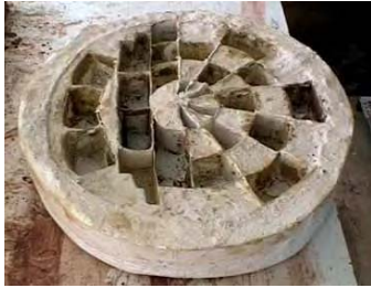
Img. 5. 6 1999 (06) Molde 1, circular, para dovelas de arcilla, para pruebas de cocción.
