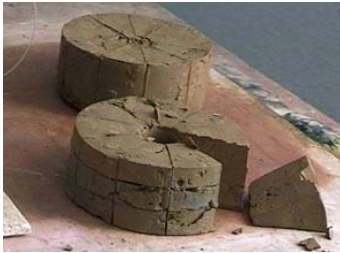
Img. 5. 26 1999 (06) Dovelas de 3ª generación de radio pequeño, en proceso de realización. Se ven las líneas de corte y una pieza ya cortada.
