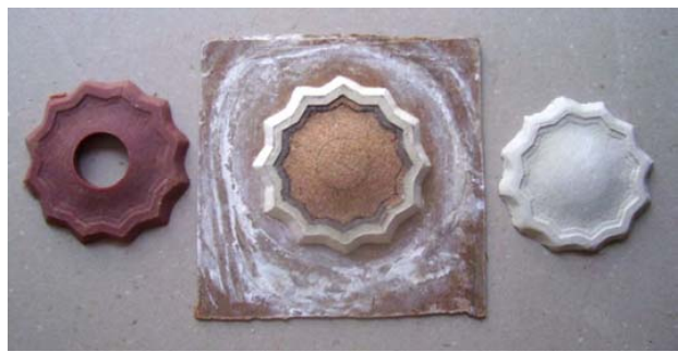
Img 9. 13. 2002. Ensayo para el escudo del surtidor: el del centro es el original, de diversos materiales, el de la izquierda de cera de fundición y el de la derecha de escayola.
