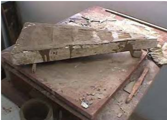
Img. 5. 16 1999 (06). Molde 3 en cuña, para dovelas de arcilla, para pruebas de cocción.
