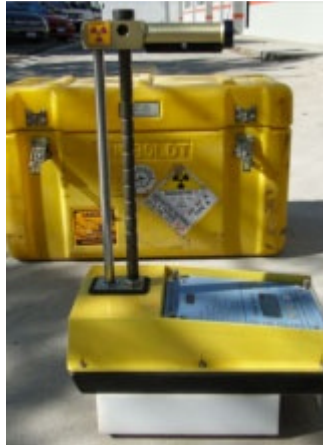
Figura 17. Aparato densímetro nuclear
