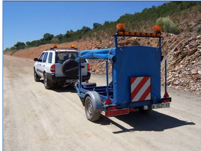
Figura 18. Vehículo deflectómetro de impacto Fuente: Gestión y Auscultación de infraestructuras, S.L.
