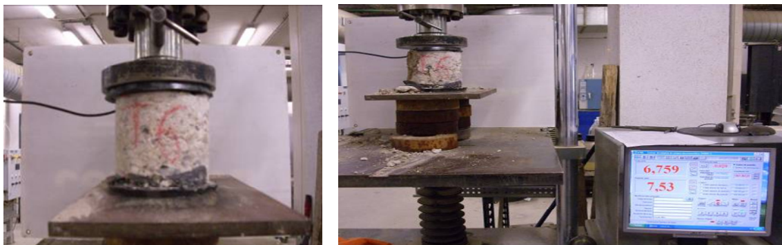
Figura 38. Probeta-testigo del ramal 1 ensayada a compresión
