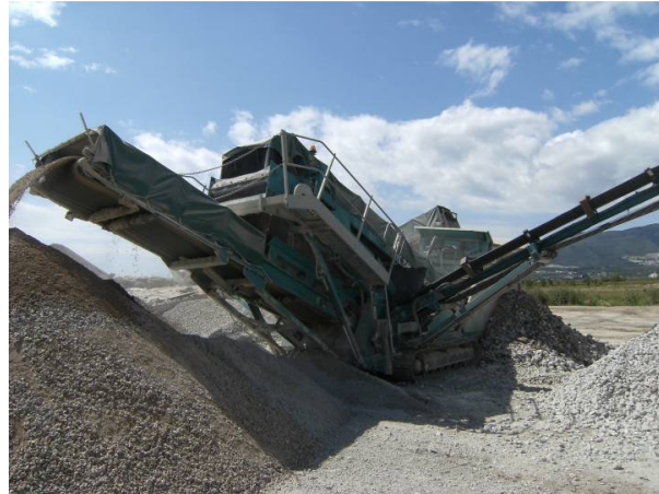
Figura 9. Cintas transportadoras y acopios de distintas granulometrías.
