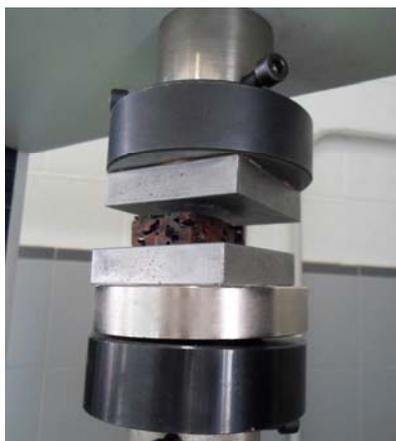
**Figura 2.3.-** Ensayo de resistencia a compresión sobre una muestra recubierta con xerogel de carbón (serie PC).
