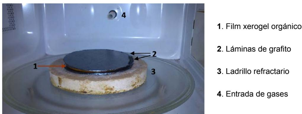
**Figura 2.1.-** Esquema del proceso de carbonización en horno microondas.
