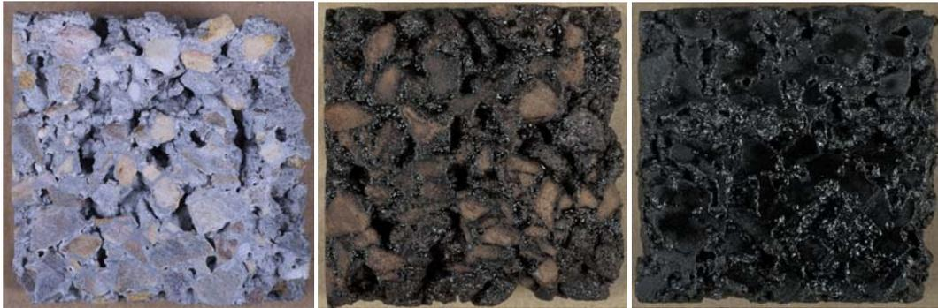
**Figura 5.1.-** Imágenes de una muestra de hormigón poroso original, recubierta de carbón utilizando como precursor R/F y recubierta de carbón utilizando como precursor PFA.
