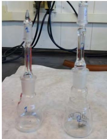
**Figura 2.7.-** Picnómetros utilizados para determinación del volumen de poros.
