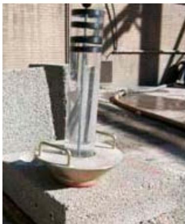
**Figura 2.4.-** Permeámetro LCS sobre una losa de hormigón poroso en las instalaciones de Cementos Portland Valderrivas.
