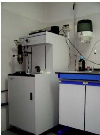
**Figura 2.8.-** Porosímetro de mercurio Autopore IV 9500.
