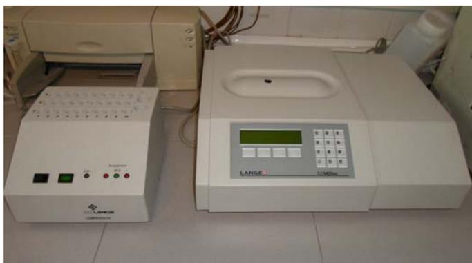
**Figura 2.11.-** Equipo LUMISTox 300 para determinación de toxicidad en los lixiviados.
