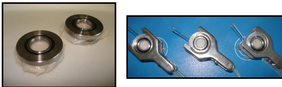
Figura 28: Discos con piel de pollo antes de la realización del ensayo y células de Franz con el disco colocado sobre el compartimento receptor sujetado con las pinzas.
