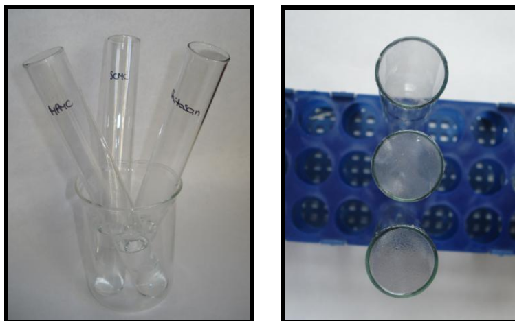
Figura 22: Tubos con las películas de los sistemas estudiados para el ensayo de permeabilidad al vapor de agua.
