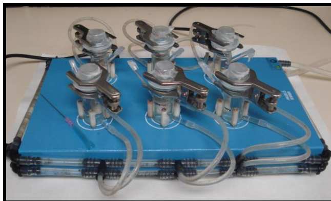
Figura 26: Células de Franz utilizadas para los ensayos de cesión de fármacos.
