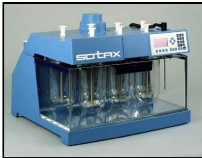
Figura 29: Dispositivo para realizar el ensayo de disolución.
