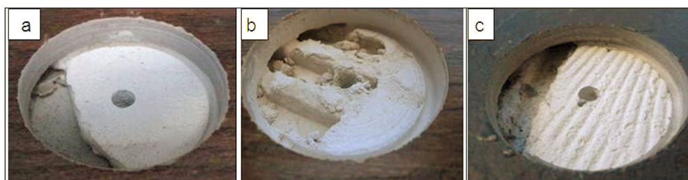
Figura 4. Análisis del trasdós de la baldosa, para comprobar la forma de colocación del adhesivo.
