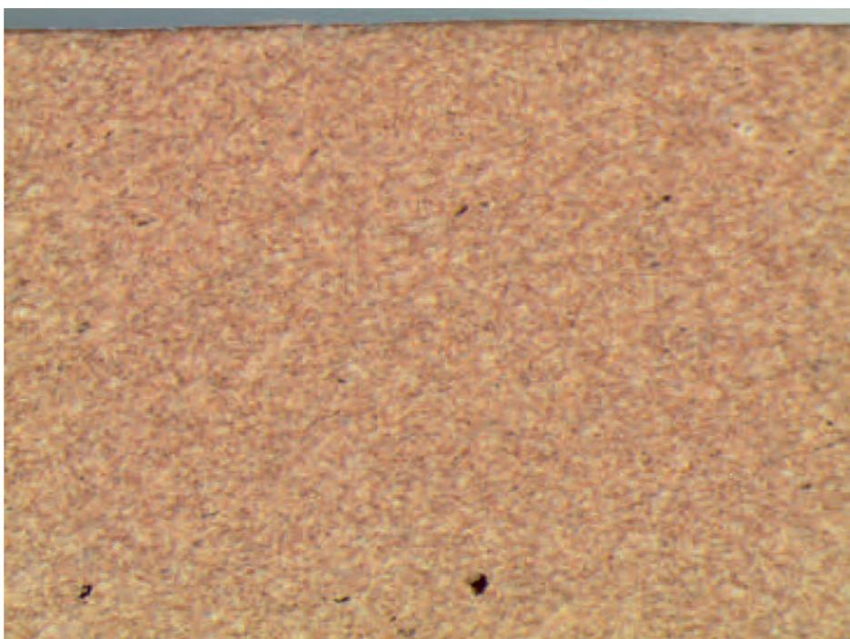
Fig. 7: Micrografía de fábrica típica de los alfares de Granada (Ancho = 6.4mm)
