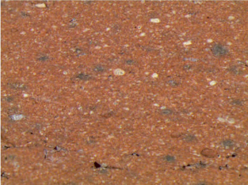
Fig. 6: Micrografía de fábrica típica de la zona antequerana (Ancho = 6.4mm)
