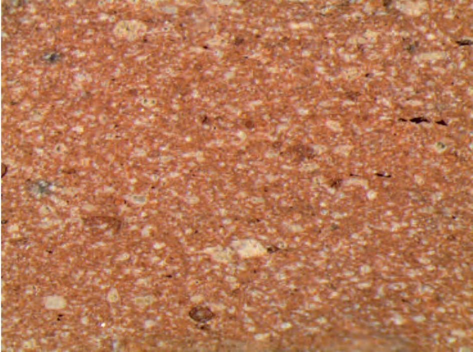
Fig. 3: Micrografía de fábrica típica de Alameda (Ancho = 6.4mm)
