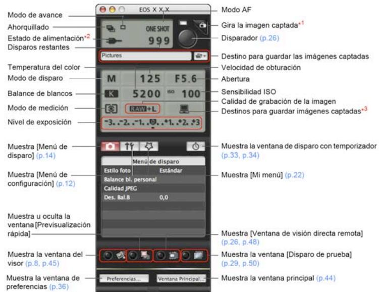
Figura 20. Ventana de comando de cámara con algunos de los principales parámetros señalados.
