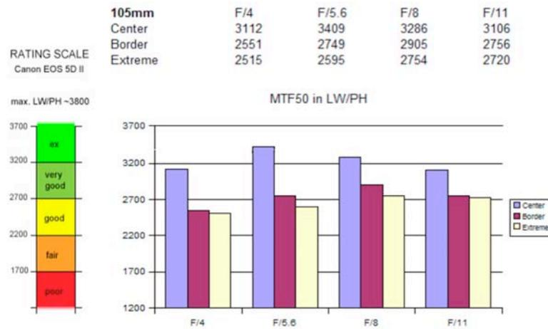
Figura 39. Escala de calidad y tabla de rendimiento de definición en la distancia focal 105mm.
