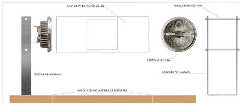
Figura 28. Componentes de la linterna de retroiluminación
