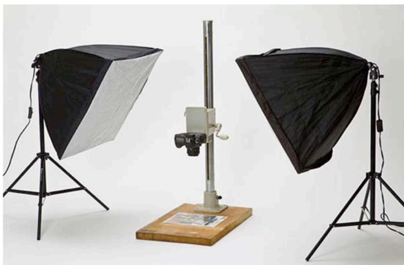
Figura 21. Sistema clásico de reproducción de opacos a través de cámara<sup>27</sup>
