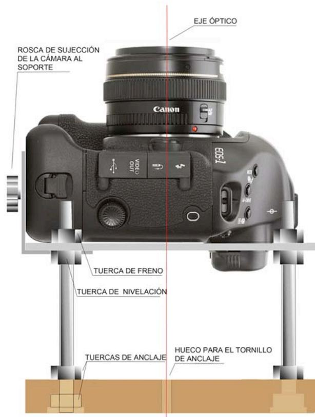
Figura 18. Esquema del anclaje de la cámara con nivelación por tuercas
