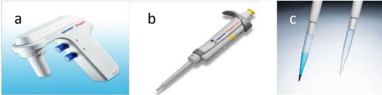
**Figura 18.** Pipetero automático(a), pipeta automática (b) y puntas de pipeta(c).
